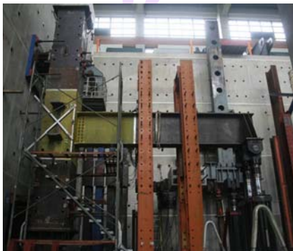
梁柱接頭試體架設照片
