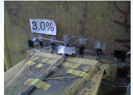
梁柱接頭試體對應上翼板之柱板受拉拱起情況
