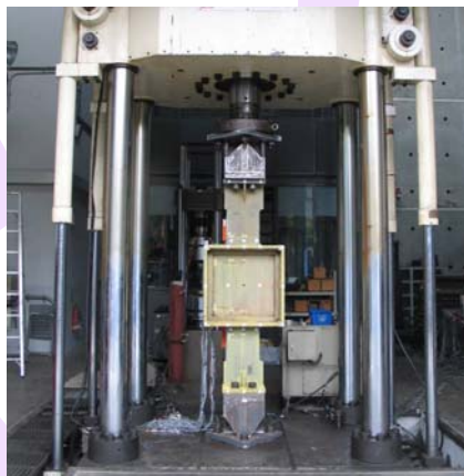
ESW元件試體架設照片
