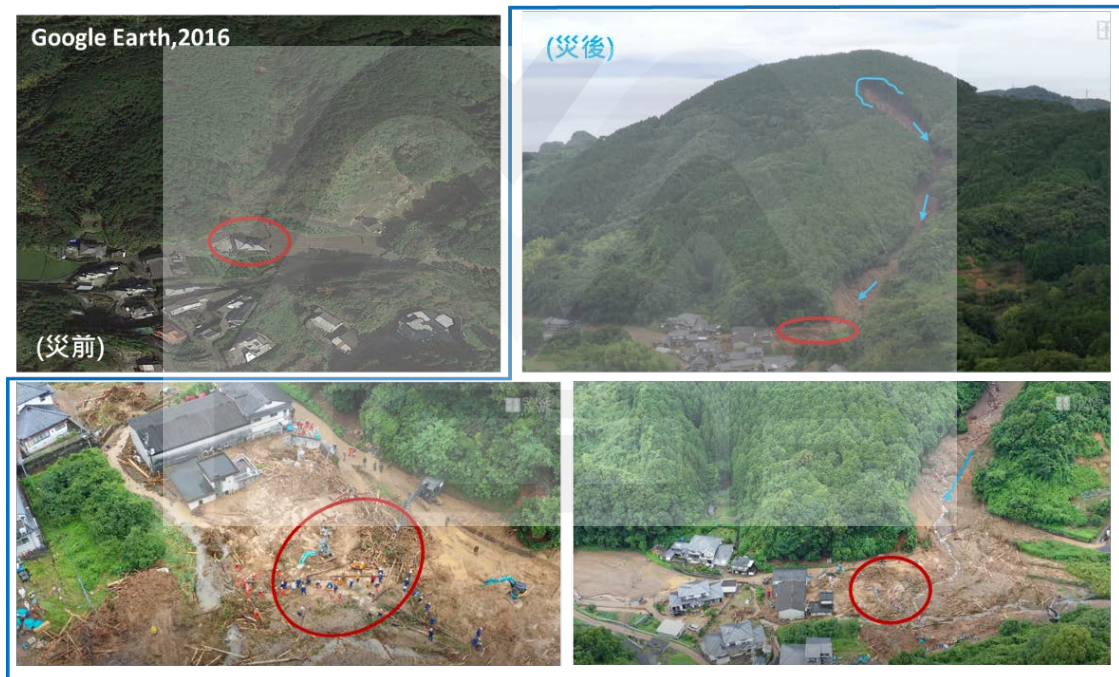
圖 32、津奈木町福浜土石流災前與災後比較圖（資料來源：GoogleEarth、災後擷自 SankeiNews youtube；災防科技中心編修）[32]
