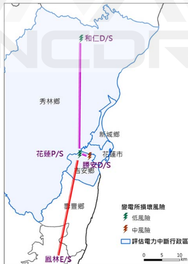
圖 4.7、2018 年花蓮地震變電所受損及供電網絡分析
