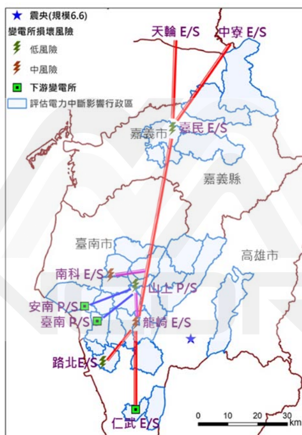
圖 4.3、2016 年高雄美濃地震變電所受損及供電網絡分析
