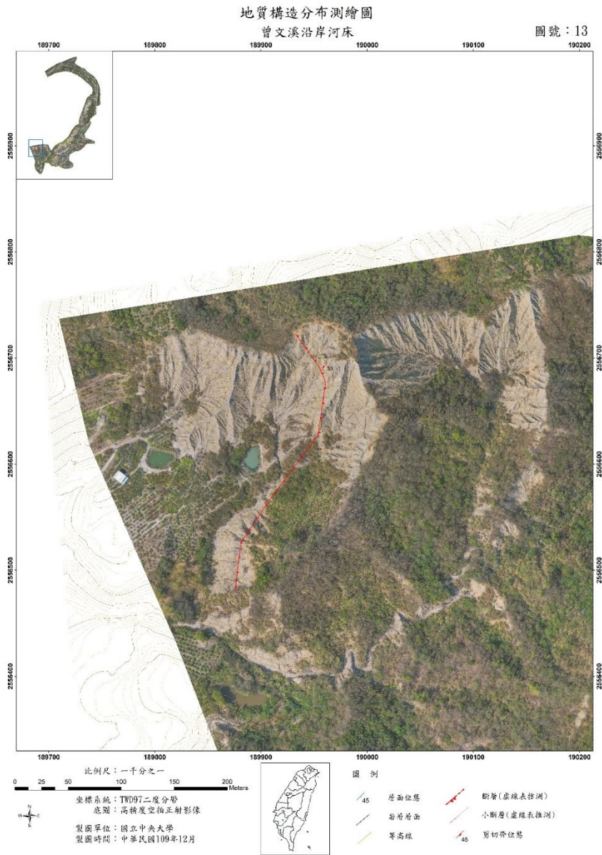
圖 2、曾文溪河床崙後斷層構造分布測繪圖(比例尺 1/1000)
