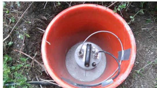
(c) 地震儀架設示意圖，其中桶內儀器必須進行指北與水平調整
