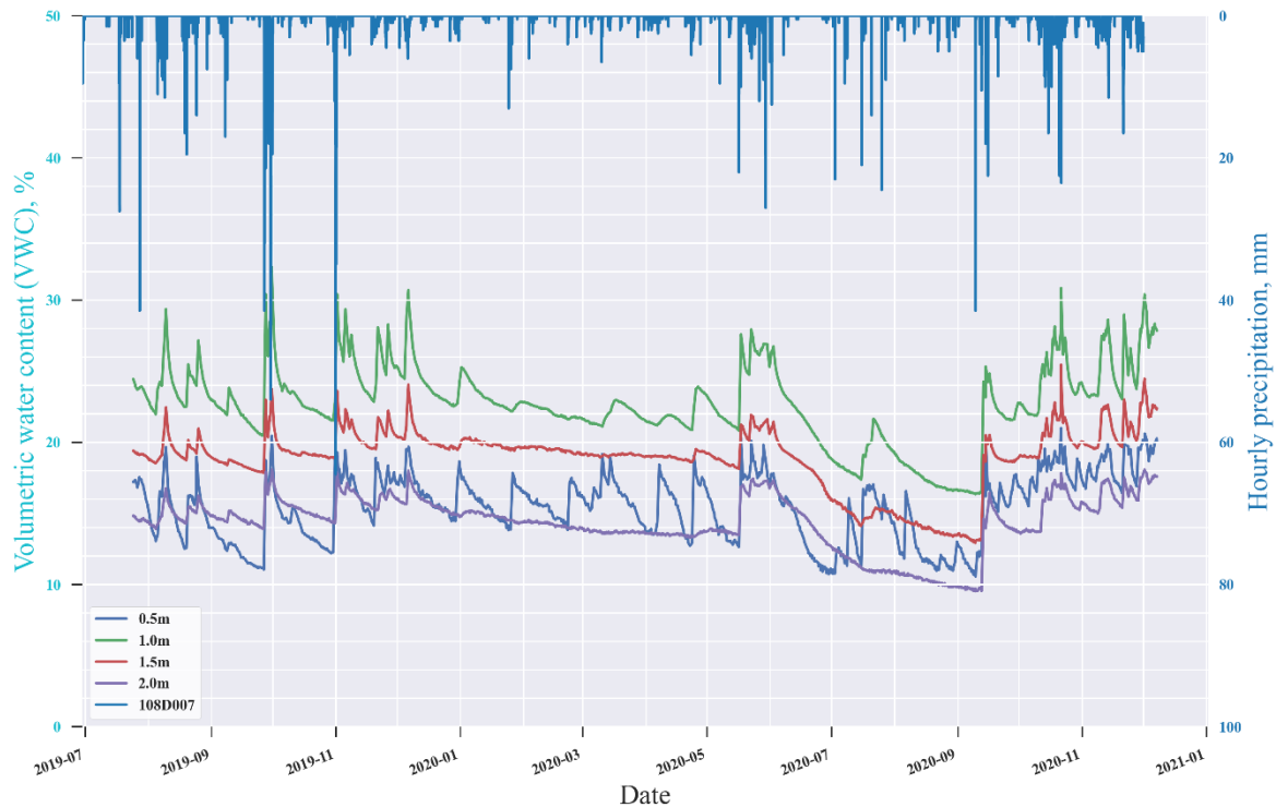
圖 6.2.2-5 108-D007-3T 土壤體積含水量變化歷線
