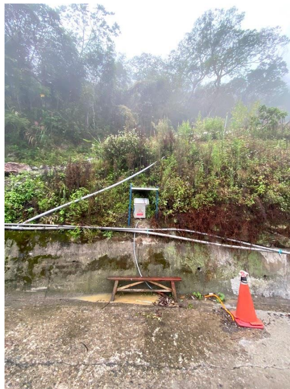
圖 4.1.2-9 109-WL-4T 監測儀器箱安裝現場配置 (TDR 剪動監測)
