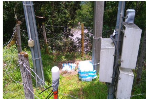
(e) 地震站架設完成遠照與地震儀使用之 GPS 架設位置示意圖
