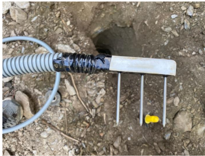
圖 4.1.2-10 Decagon 土壤含水量感測器 GS3
