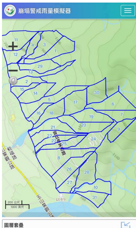
圖 4-12 崩塌警戒展示模組--豐丘聚落坡面單元
