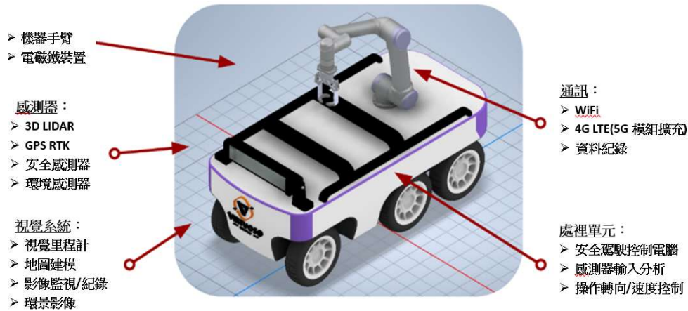
圖 32 遙控行動式輻射偵測平台設計模型
