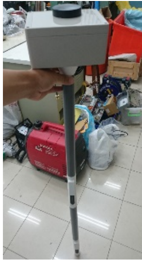
圖 3.9 土層監測模組外構
