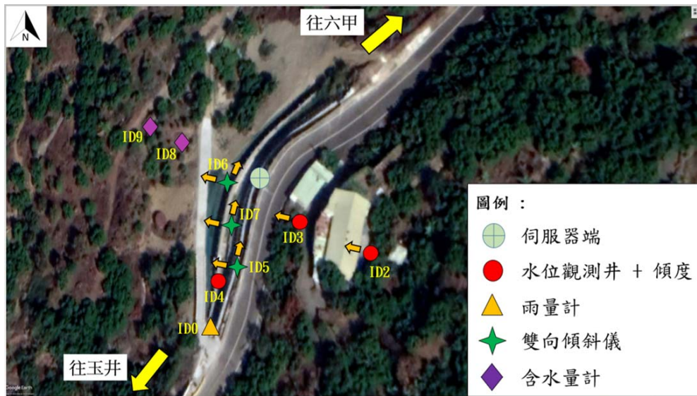
圖 5.23 南市道 175 線場址監測模組配置
