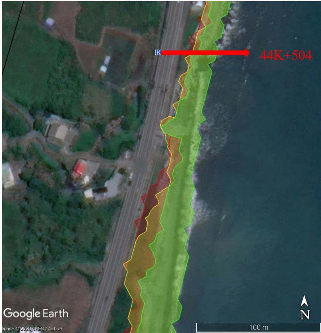
圖 3.33 區域 4 的 44.5K 到 44.7K 道路邊緣出現溢淹
