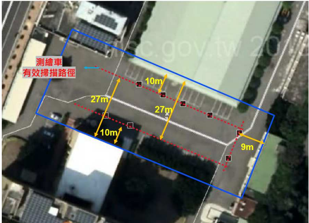
圖 3-10 光達測繪車掃描路徑規劃示意圖
