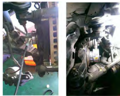
圖 2-8 輪速計安裝情形
