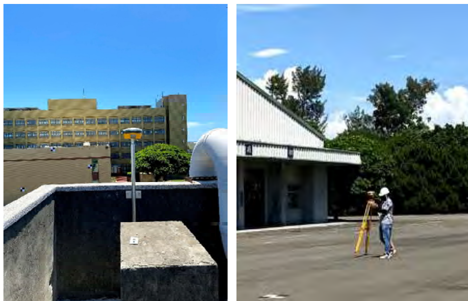
圖 3-67 校正標位置測量—eGNSS 即時動態定位測量固定點坐標
