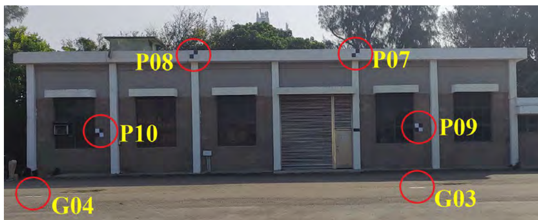
圖 3-8 校正標安裝位置示意圖-2
