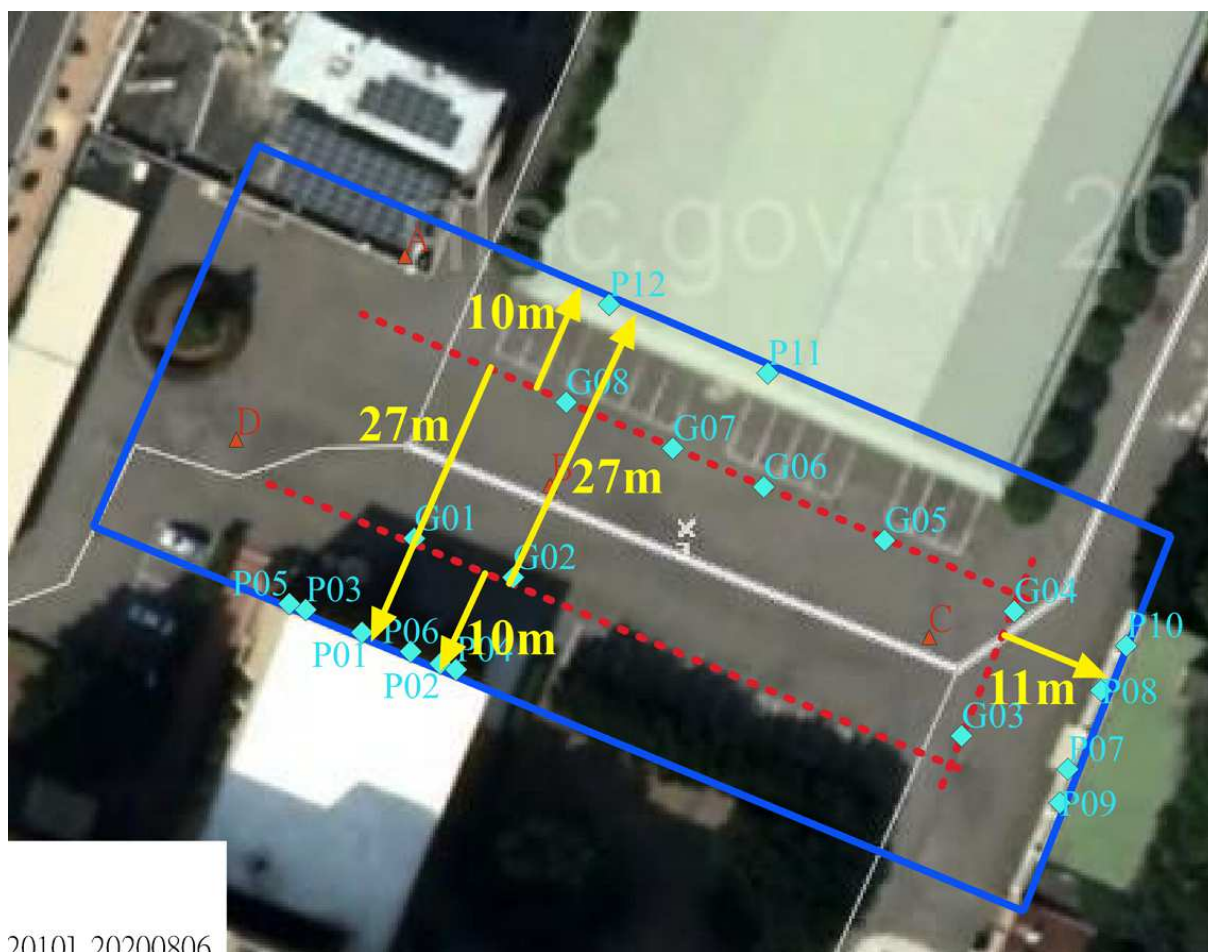
圖 3-70 校正掃描路線與牆面校正標連線水平距離示意圖
