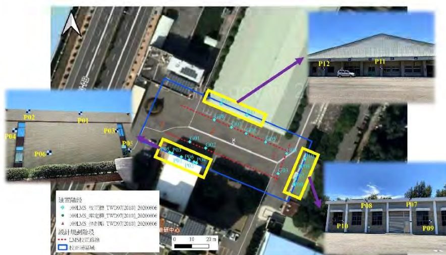
車載光達校正場範圍及校正標分布
