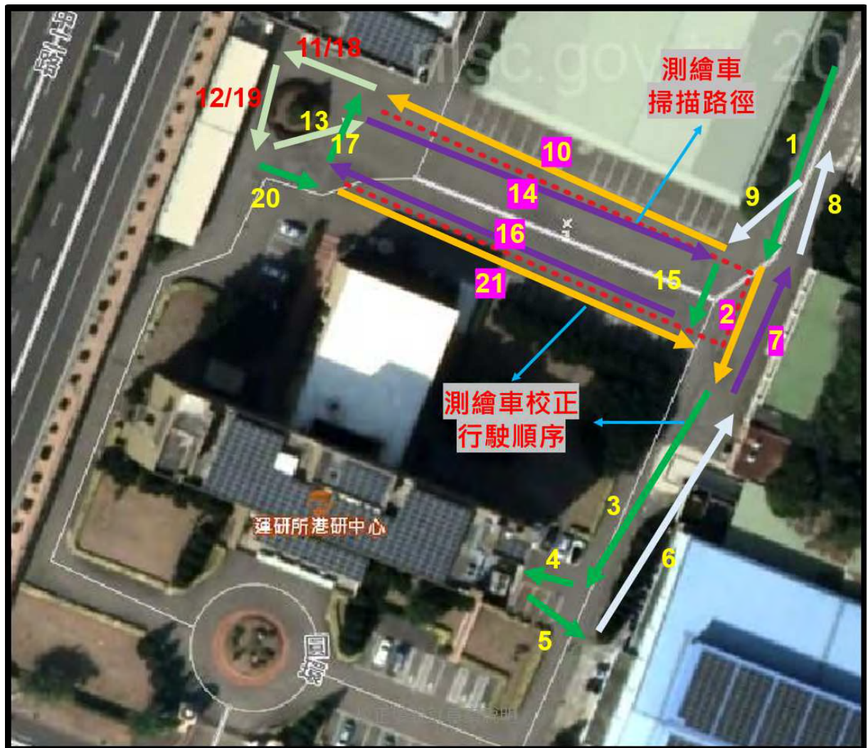
圖 3-12 光達測繪車於掃描路徑行駛順序示意圖（路線 2）
