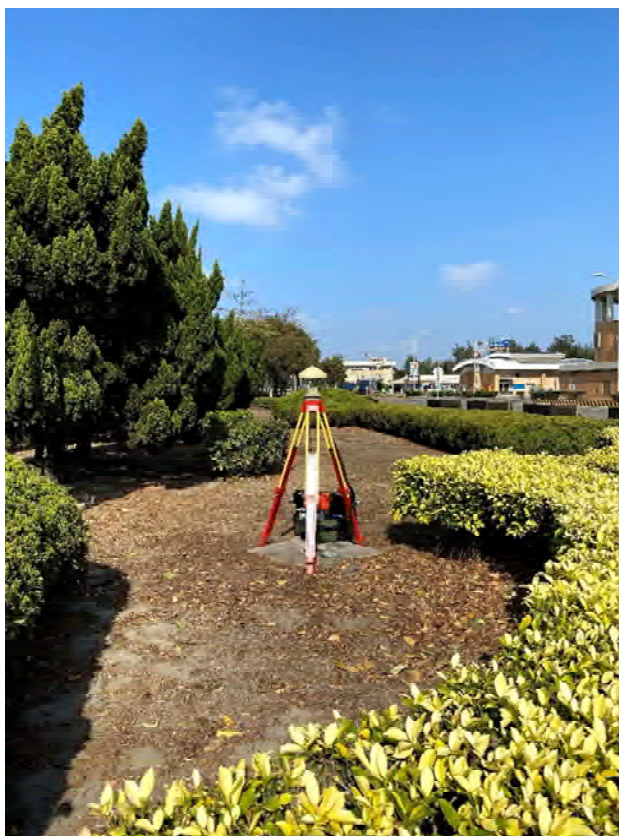
圖 4-17 校正標坐標參考值量測作業－衛星控制點聯測 (M906)
