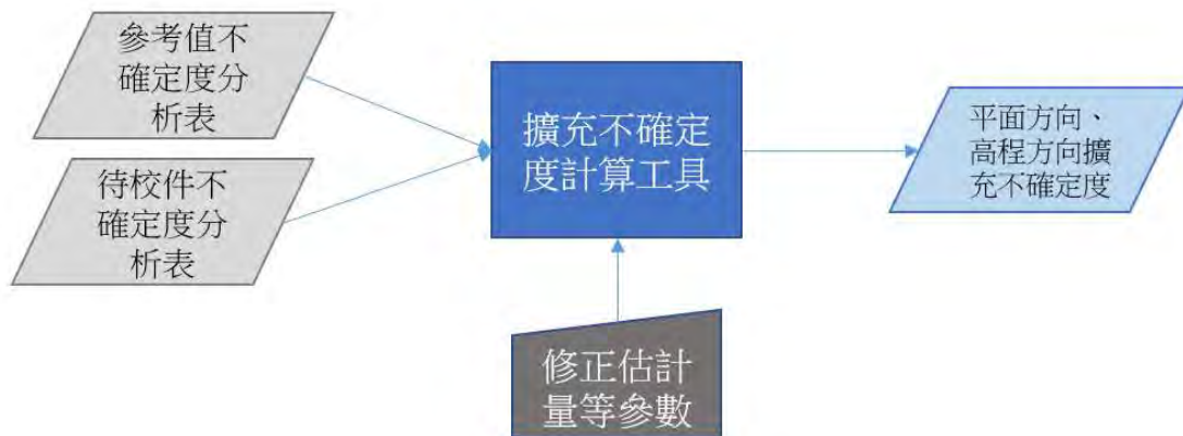
圖 6-8 擴充不確定度計算工具—操作流程
