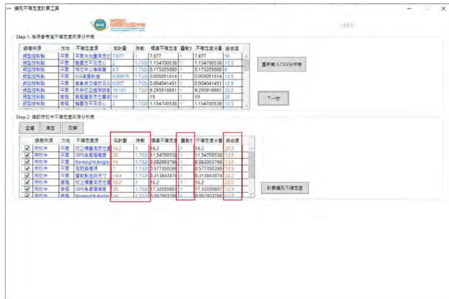
圖 6-11 擴充不確定度計算工具—可分別輸入各影響因子不確定度估計量
