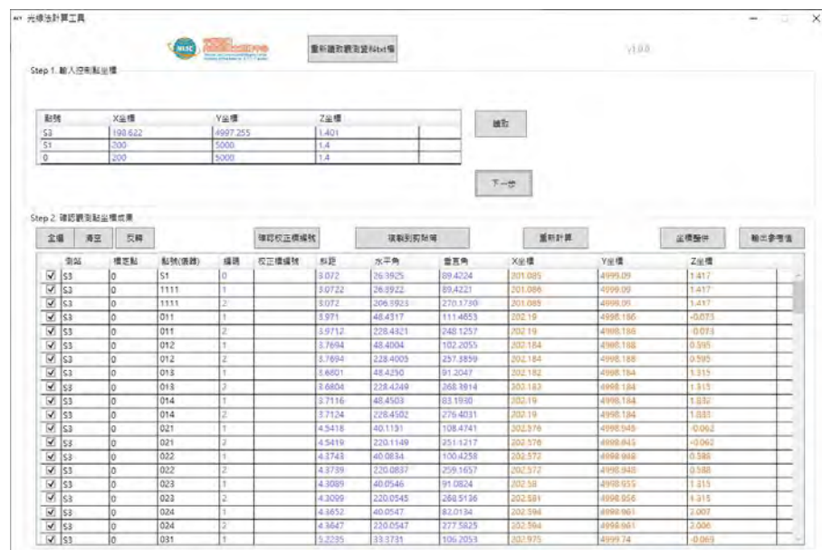
圖 6-5 光線法計算工具—載入固定點坐標並計算初始坐標
