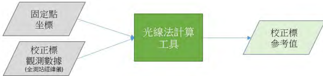
圖 6-2 光線法計算工具—操作流程
