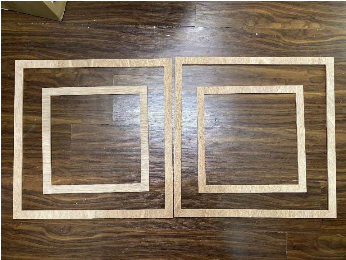
圖 3-37 貼附磁鐵輔助木框（採 CNC 裁切）
