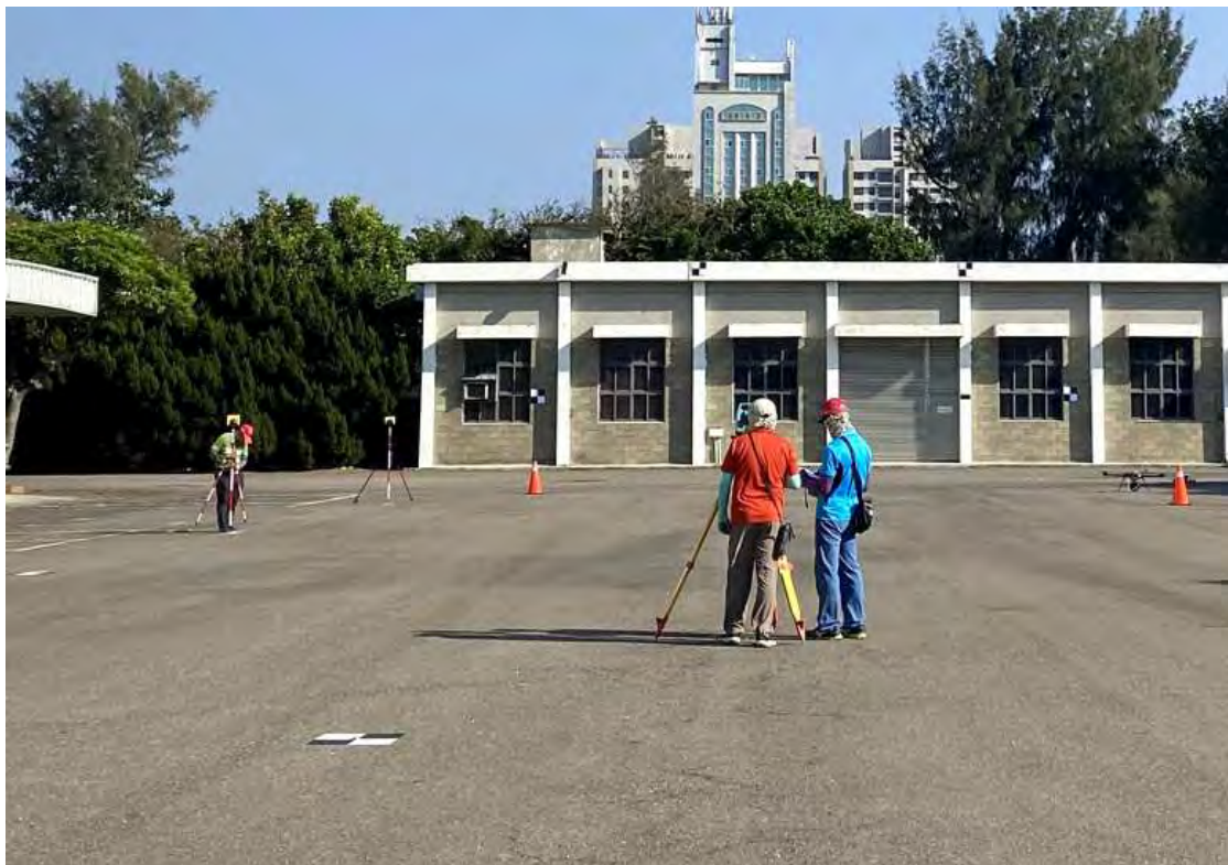
圖 4-20 校正標坐標參考值量測作業—全測站量測校正標參考坐標
