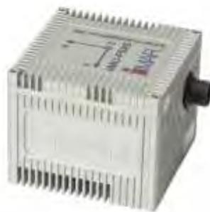
圖 2-6 選用之慣性量測元件
