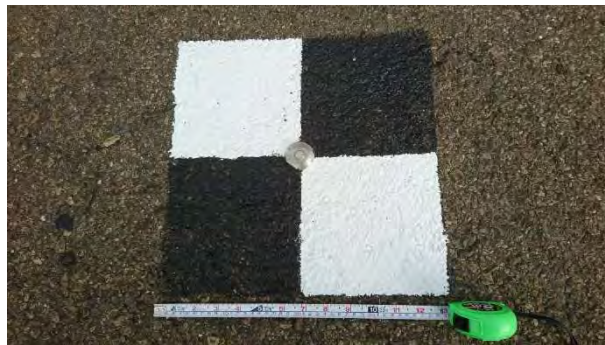
圖 3-59 地面校正標施工建置完成—尺寸確認
