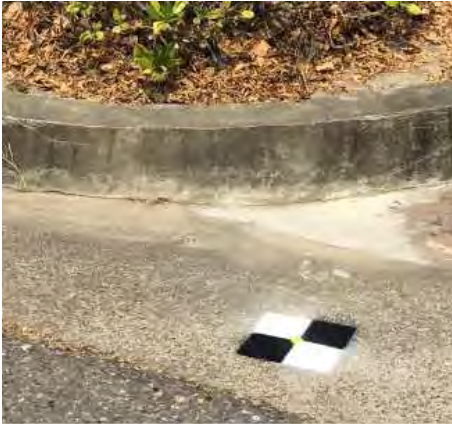
圖 3-31 地面校正標示意圖
