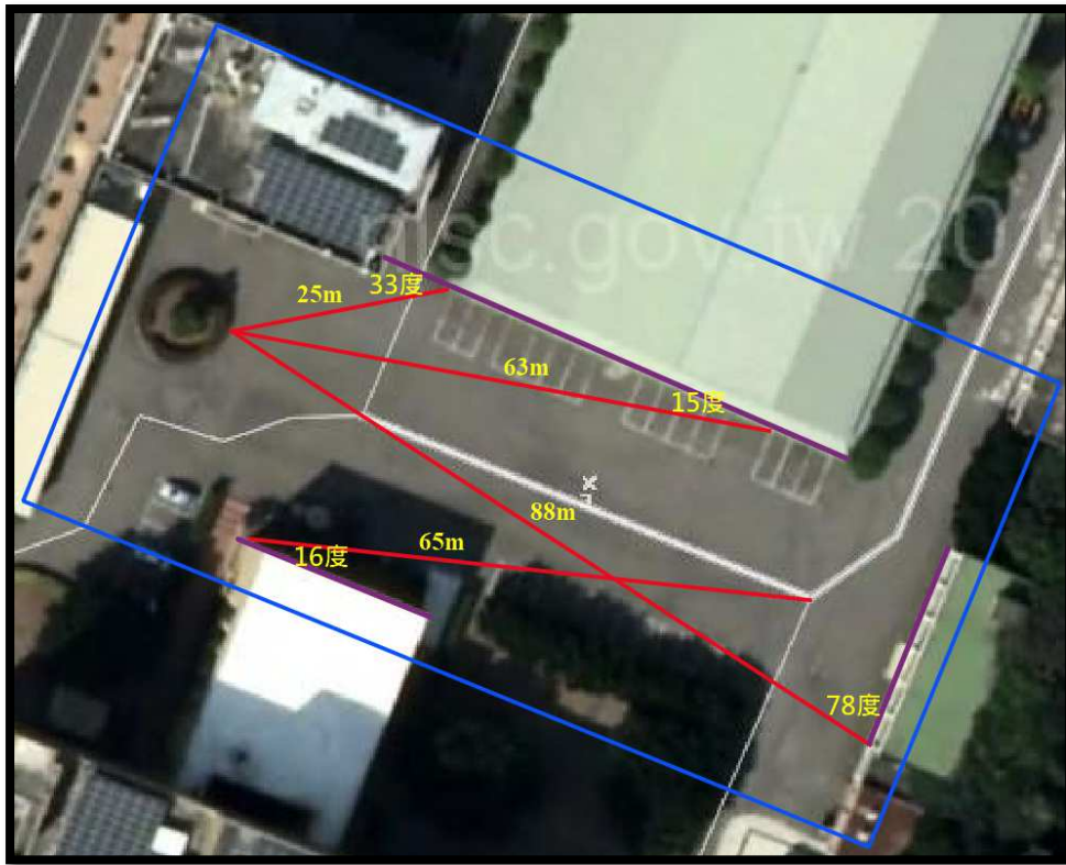
圖 3-20 全測站儀免稜鏡測距測試—校正標角度與距離設定依據
