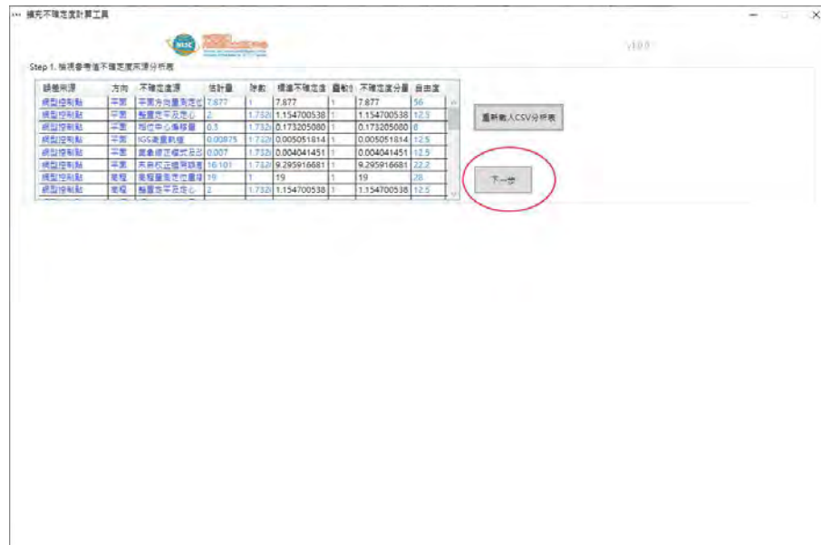
圖 6-10 擴充不確定度計算工具—載入待校件不確定度分析表範例
