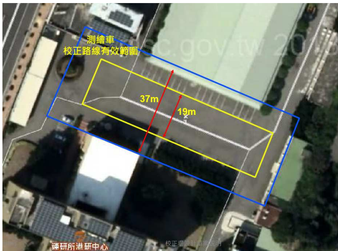
圖 3-3 場勘光達測繪車校正活動範圍示意圖
