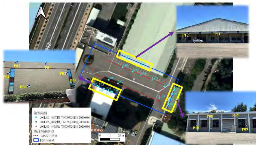
車載光達校正場範圍及校正標分布
