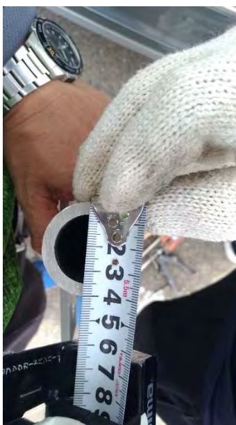
圖 3-64 GNSS 靜態基站鋁管管壁厚度
