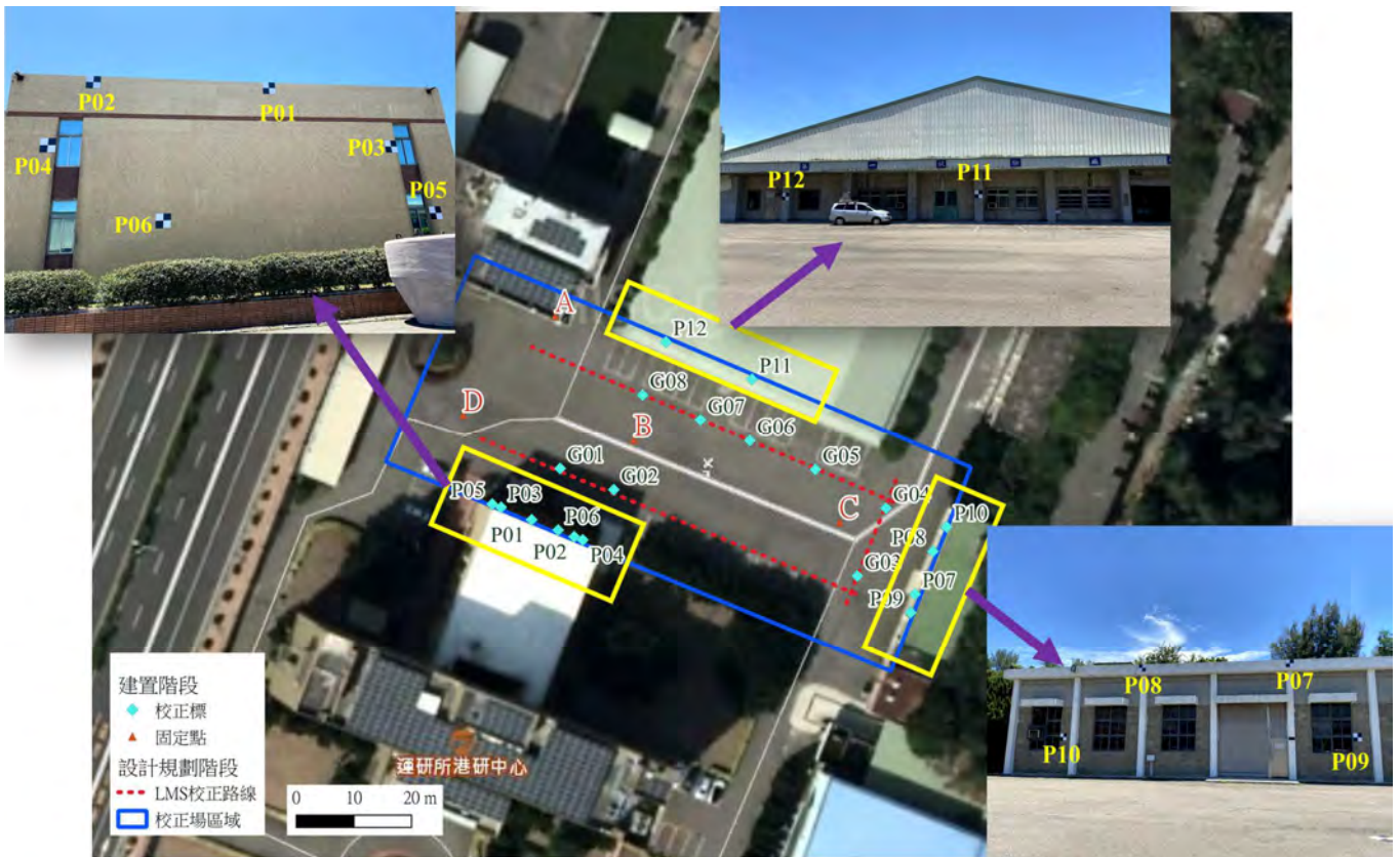
圖 4-3 校正場固定點與校正標分布示意圖
