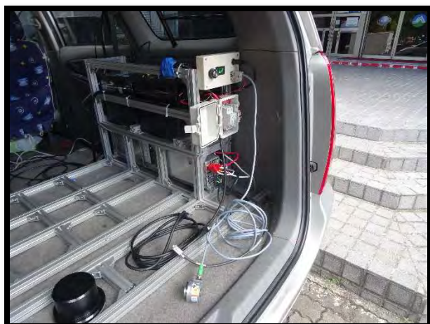
圖 7-7 第 3 次保養維護作業－外掛輪速計測試
