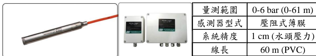
圖 2.2-4 本研究採用之自動化連續記讀水壓觀測計模組
