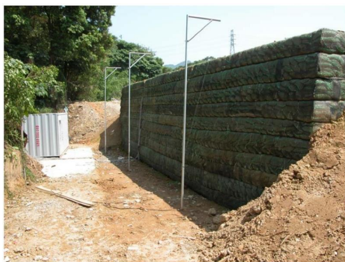
圖 2.4-1 大尺寸加勁擋土牆模型實驗照片(楊錦裕 2004)
