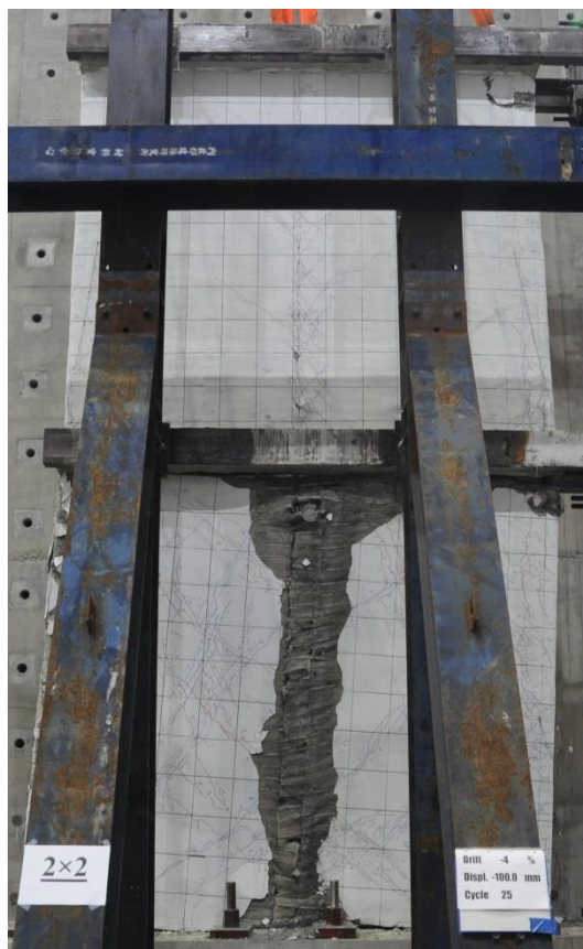
圖 4.22 2x2 試體不同層間位移角試體破壞情況(續)
