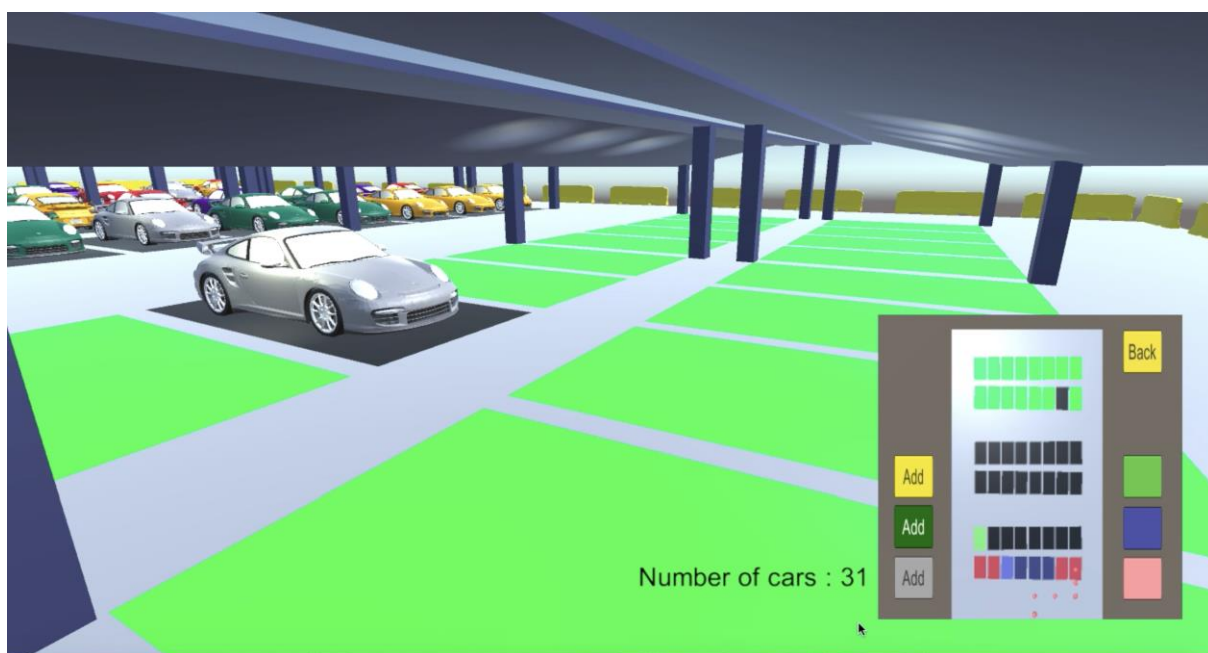
(c) 根據車輛數量及停放位置開啟照明設備
