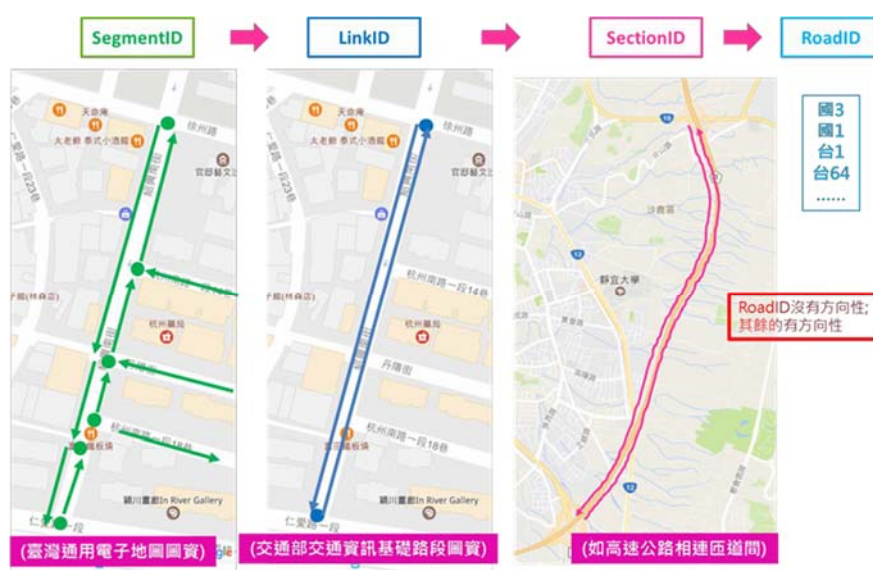
圖 2.10 Segment-Link-Section-Road 資料代表涵義示意圖(摘錄自交通部即時路況資料標準 V2.0)
