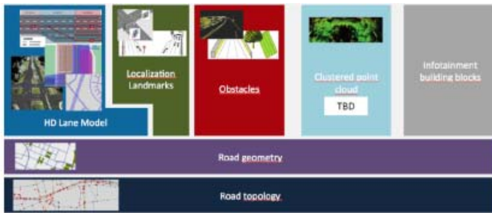
圖 6.5 NDS 系統架構圖(摘錄自 Sasse, 2017)
