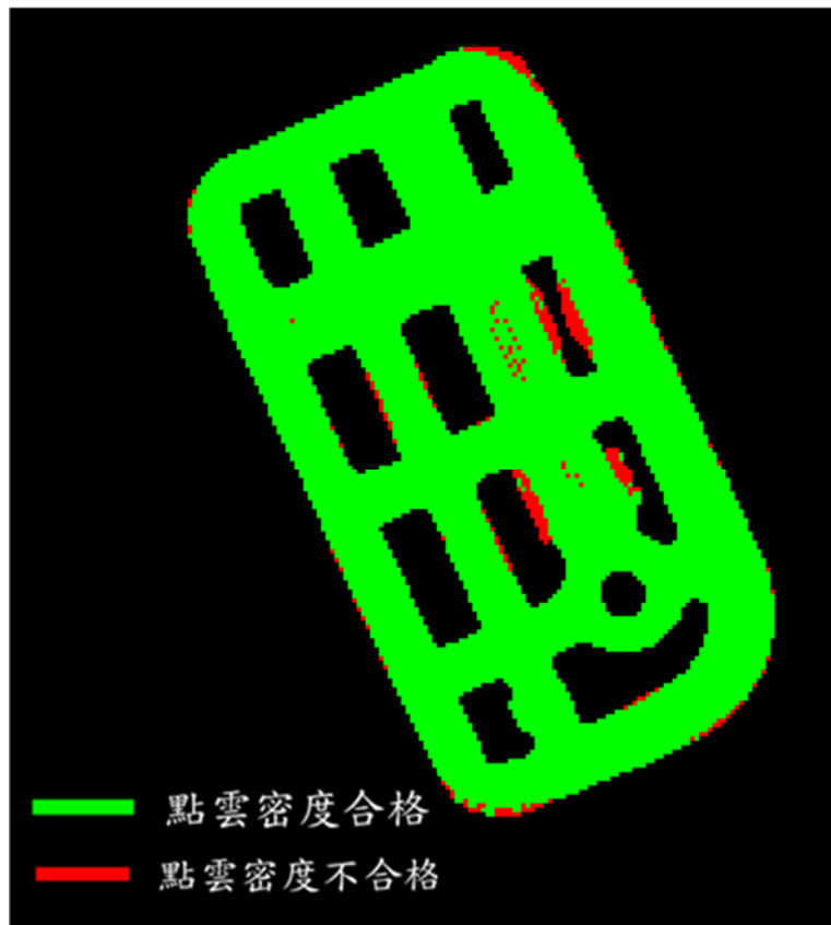
圖 8.3 點雲密度檢核成果示意圖
