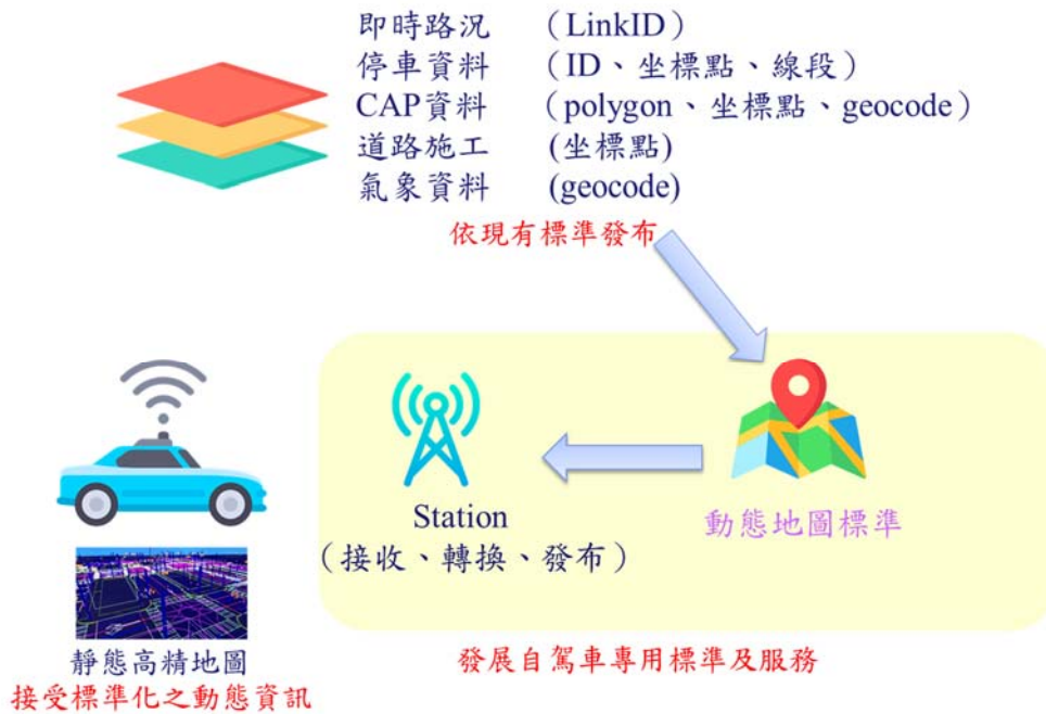
圖 2.38 動態地圖標準發展架構
