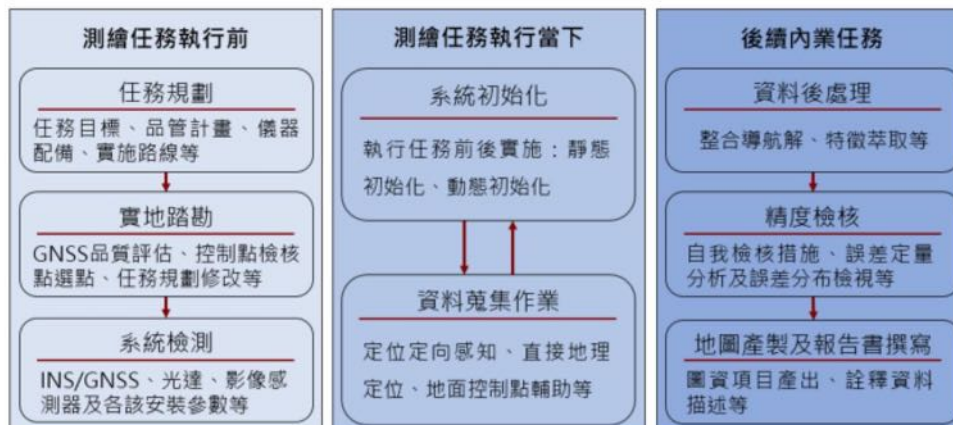
圖 2 高精地圖製圖作業之車載行動測繪系統流程
