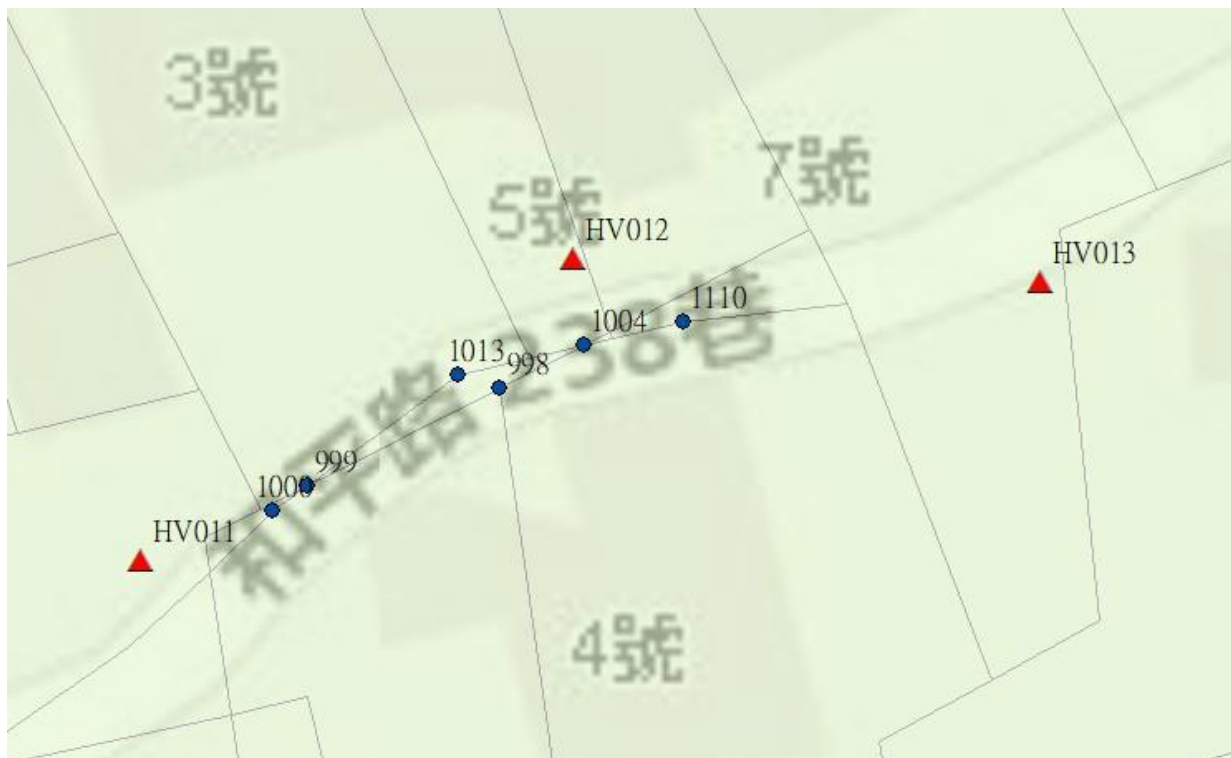
圖 9.15 透空較佳之測試區域：解算之界址點套疊地籍圖（比例尺 1/250 檢視）
