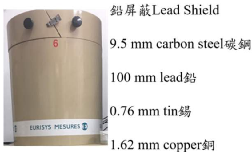
圖 4 高純鍺鉛屏蔽結構介紹圖
