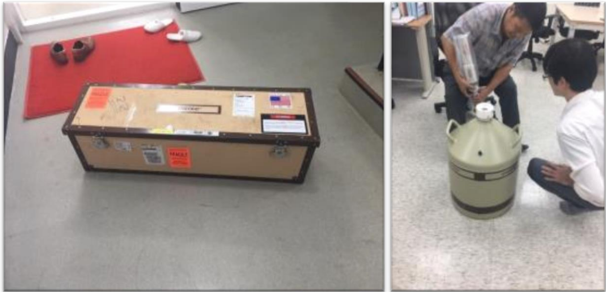
圖 1 原廠設備運送箱(左) 純鍺偵檢器晶體與液態氮桶安裝程序(右)
