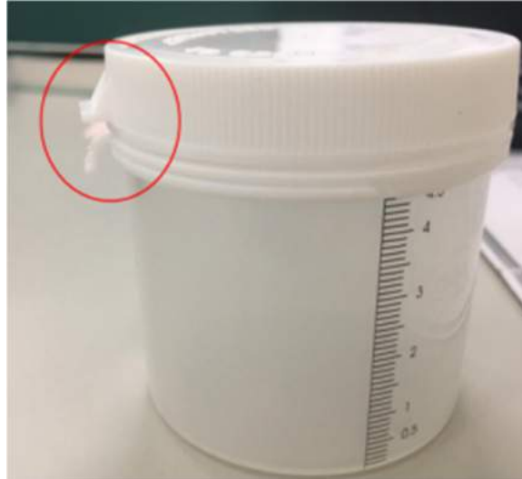
圖 14 試樣計測皿蓋子突出點
