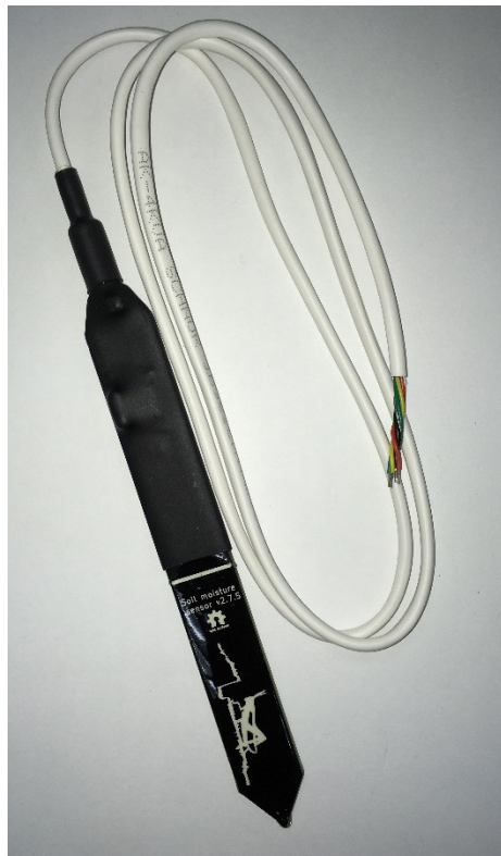
圖 3.2 電容式土壤水份計
