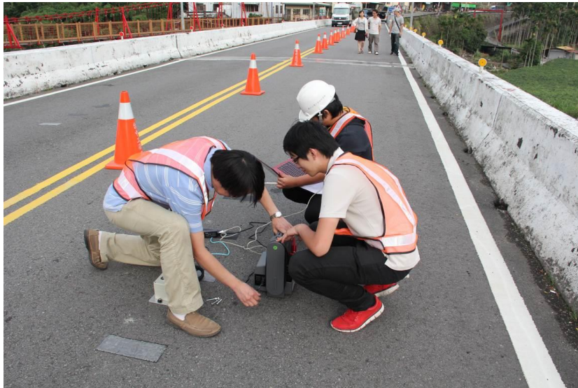
圖 6.23 以備用電源供應筆電與速度計之電力
