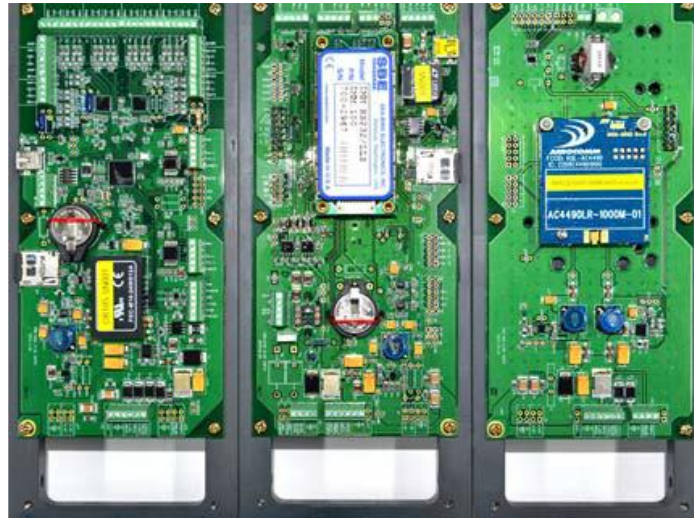
圖 65 由左至右分別是控制 MAU 之電路板 ORB-958A，以及控制 CCU 的 ORB-918C 與 ORB-988A 之電路板。
