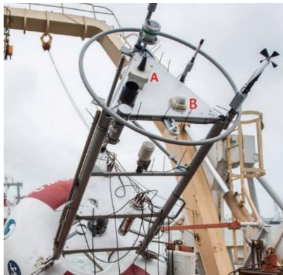
圖 56 雙衛星傳輸系統安裝於浮標上之外觀，A 為鈹衛星傳輸系統、B 為 INMARSAT 傳輸系統。
