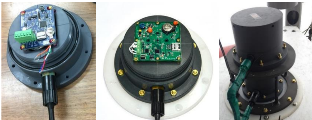
圖 58 由左至右分別為用外購晶片開發之波浪儀內部樣式、自行開發晶片之浪儀內部樣式、安裝於浮標上之外觀。
