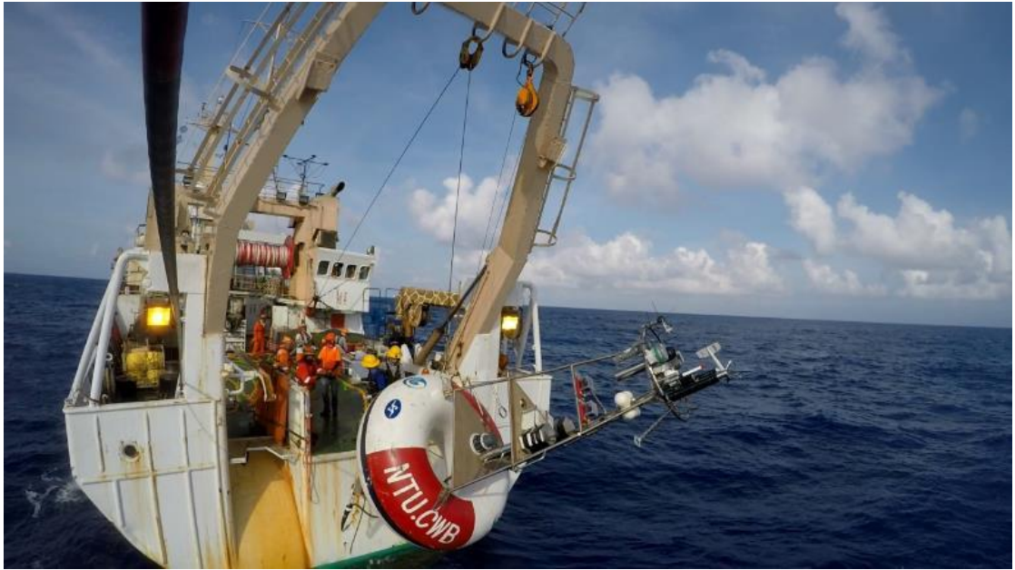
圖 69 海氣象浮標浮體施放作業情形
