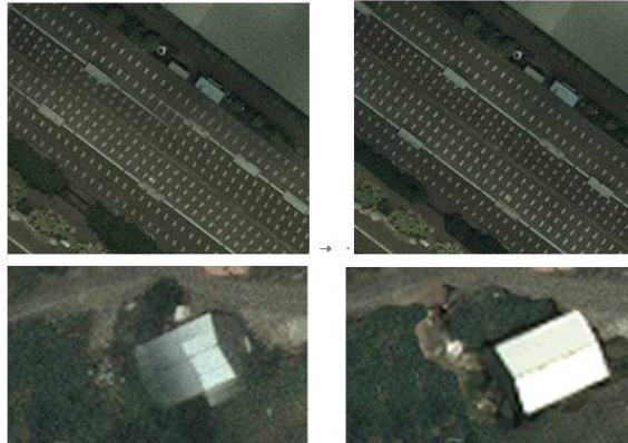
圖 2-41 正射影像編修前後比較(左邊為編修前、右邊為編修後)
