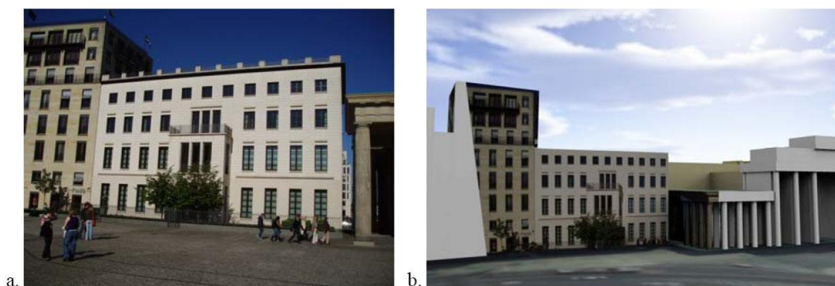
圖 6.2-5、(a)房屋牆面近景影像 (b)牆面敷貼紋理之房屋模型 (OGC, 2012)
