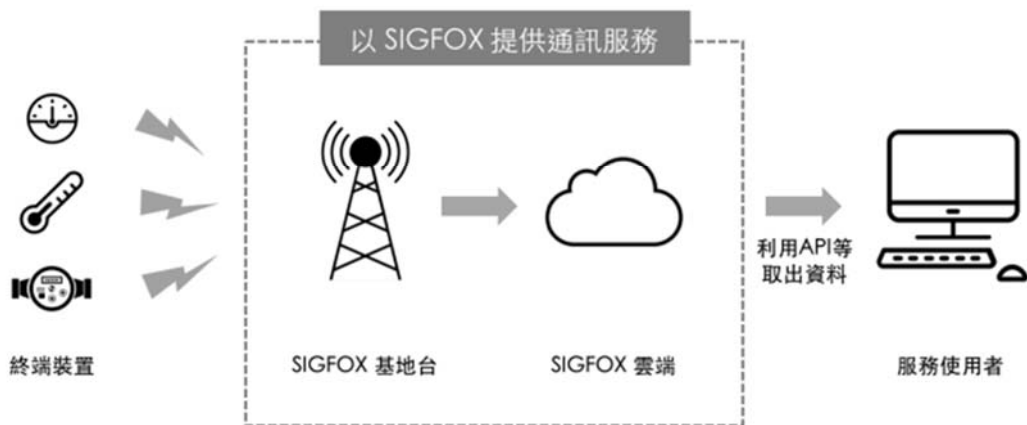
圖 4-21 SIGFOX 無線通訊系統架構圖
