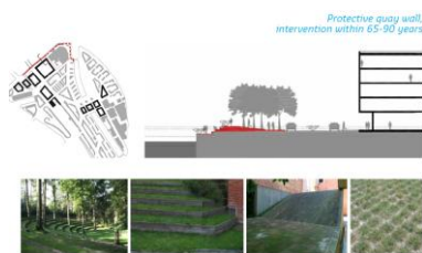
圖2-3-10 岸邊作階梯式的堤防或坡地
