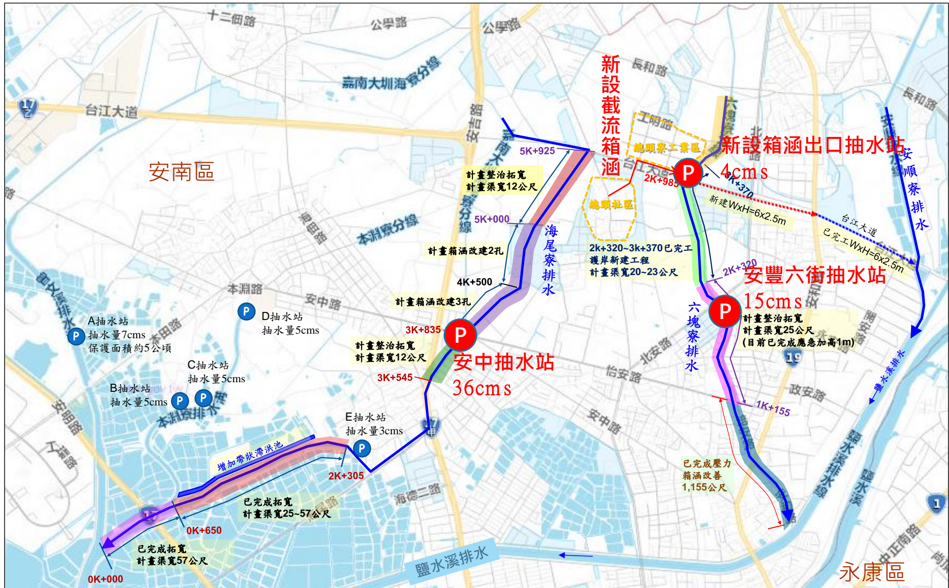
圖 3-7 鄰近排水路治理工程現況示意圖
