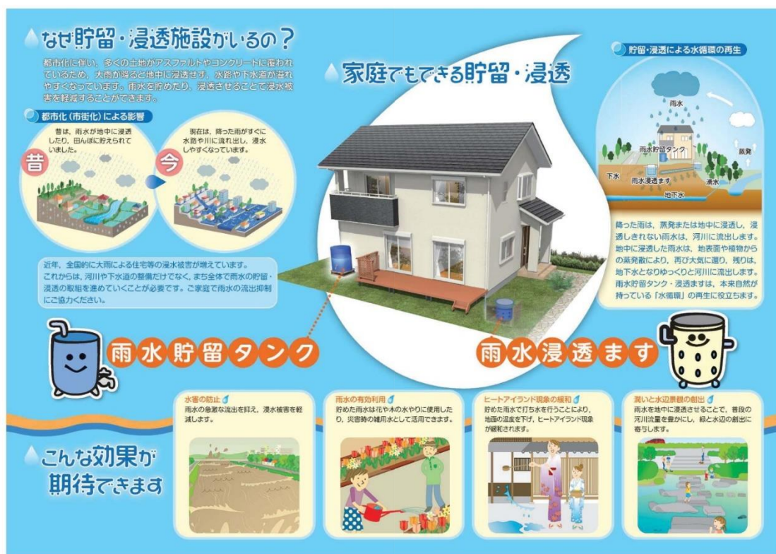
圖 4-19 家庭雨水儲存、滲透設施設置說明
