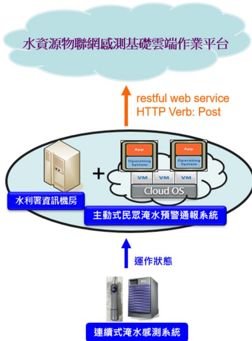
圖 4.2-5 感測器運作狀態上傳「水資源物聯網平台」架構圖
