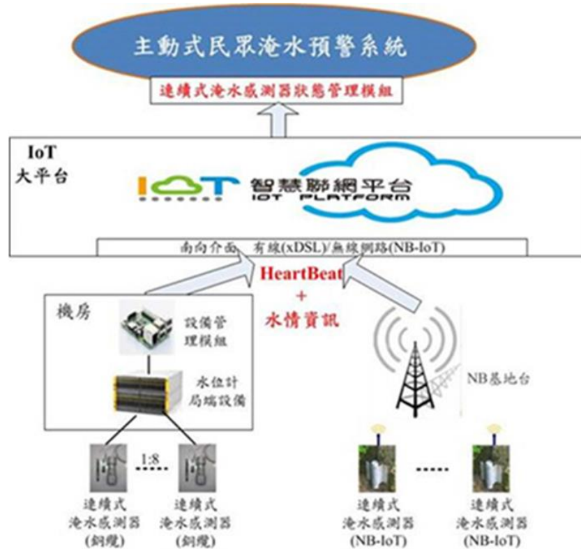
圖 4.1-1 連續式淹水感測器狀態管理架構
