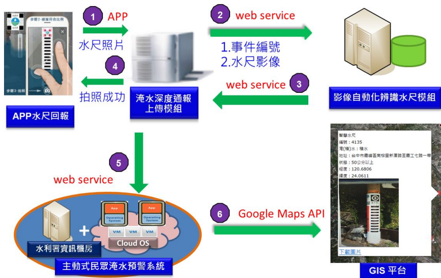
圖 5.0-2 水情通報 APP-水尺回報通報流程
