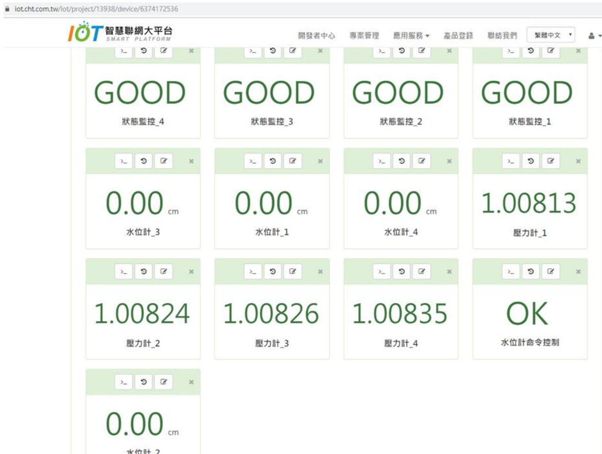
圖 4.1-3 銅纜連續式淹水感測器狀態監控與淹水感測器之關聯
