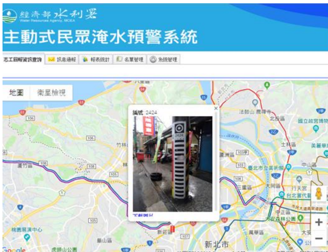
圖 5.1-4 淹水預警系統 GIS 圖台顯示 2424 水尺
