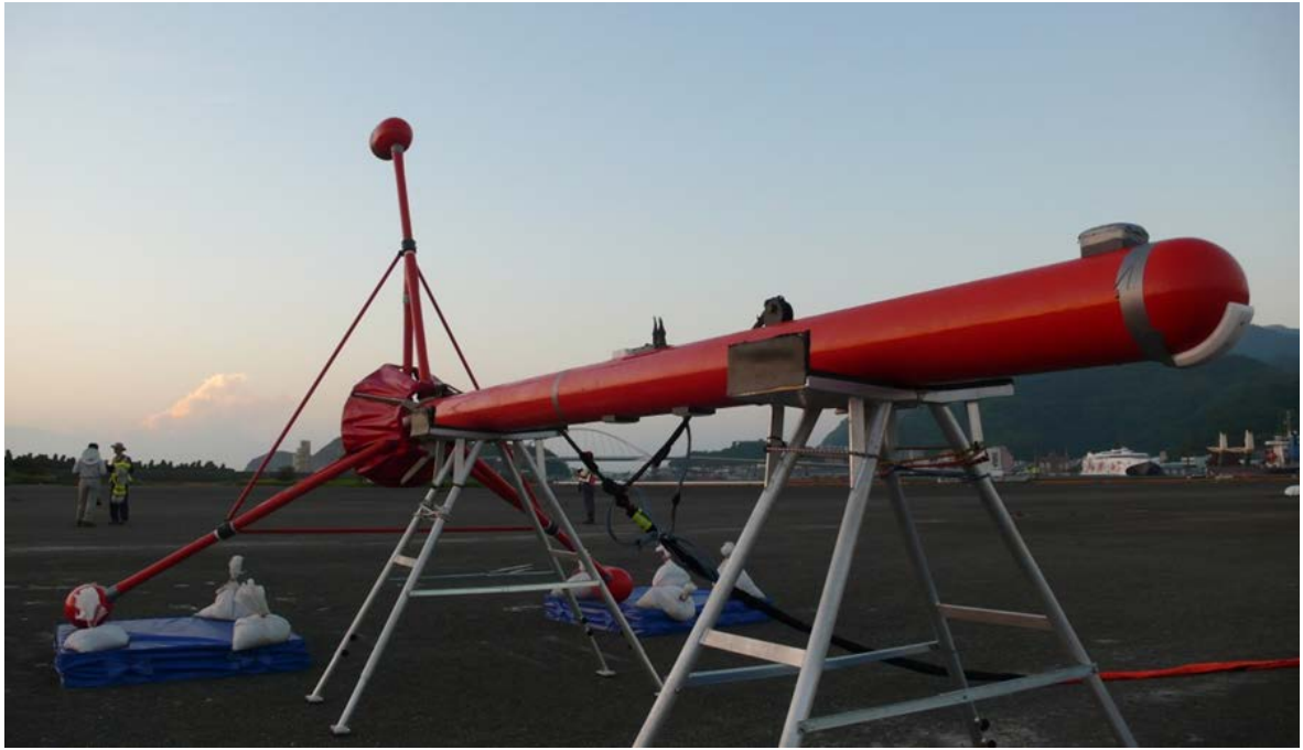
圖 1-1：地調所引進的三軸拖鳥設備
