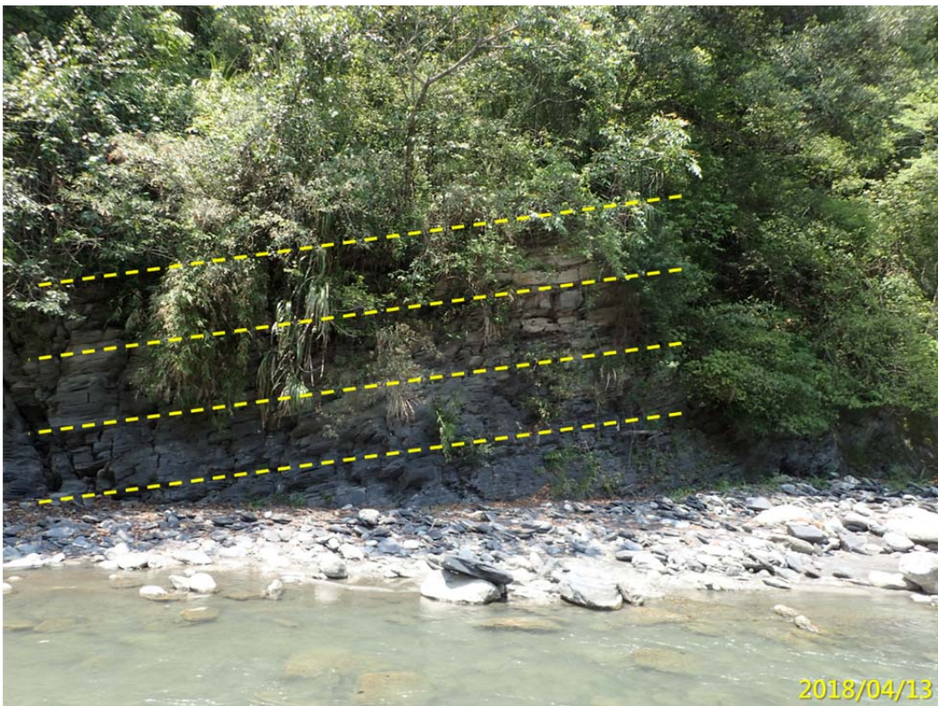
圖 3-21、廬山聚落坡趾露頭。位於塔羅灣溪附近，岩性主要為板岩間夾砂岩
