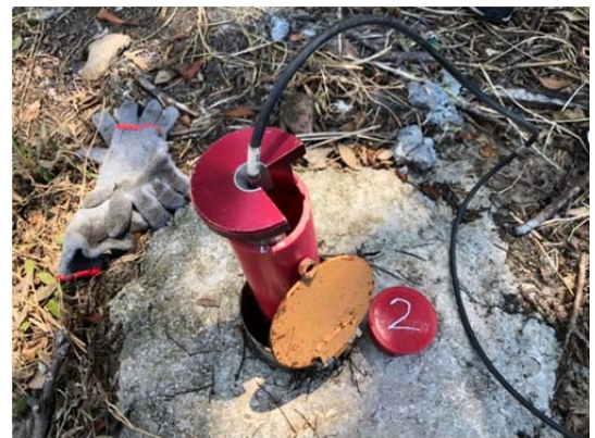
現場測傾管照片
