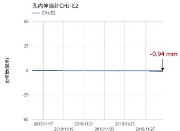
(b) CHJ-E2 孔內伸縮計(與測傾管共構)
