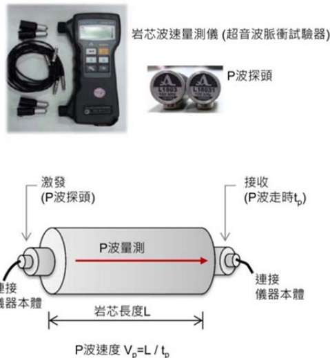
圖 2-6、岩芯波速量測示意圖
