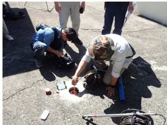
(b) 現場水位指示器操作情形 (2019/07/31)
