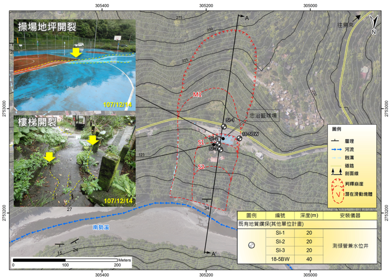
圖 6-6、忠治籃球場既有地質鑽探及測傾管平面位置圖
