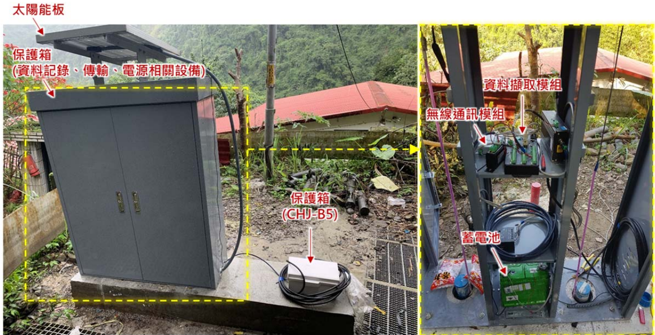
圖 6-19、現場自動化測站設置情形 Fig. 6.19 In-situ automatic observation station
