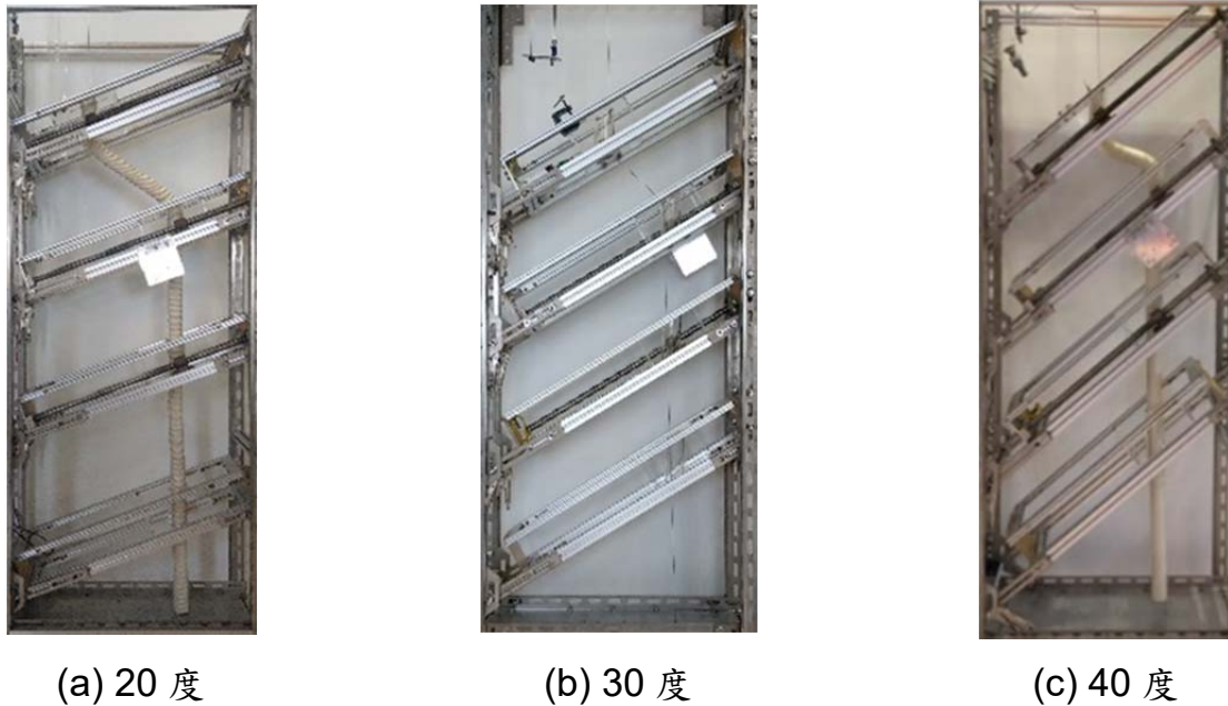
圖 6-33、不同滑動面傾角之試驗 Fig. 6.33 Test of different sliding angle
