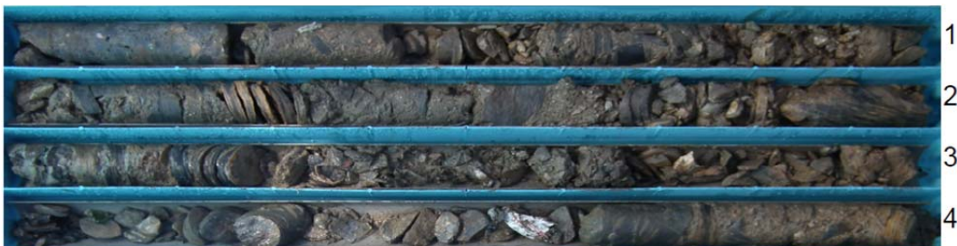
圖 3-11、廬山聚落 LS-B2 岩芯照片(深度 1~4m)
