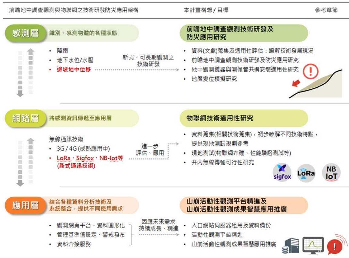
圖 6-1、物聯網架構 Fig. 6.1 Structure of internet of things
