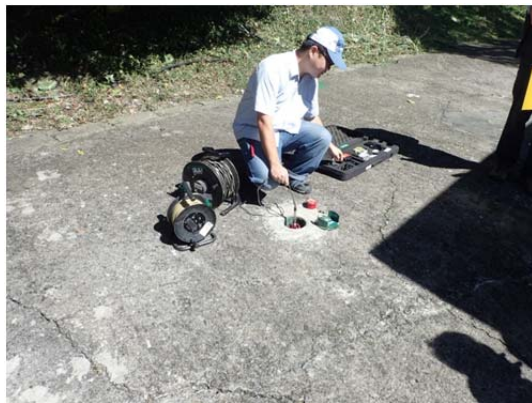
(a) 現場測傾儀操作情形 (2019/07/31)
