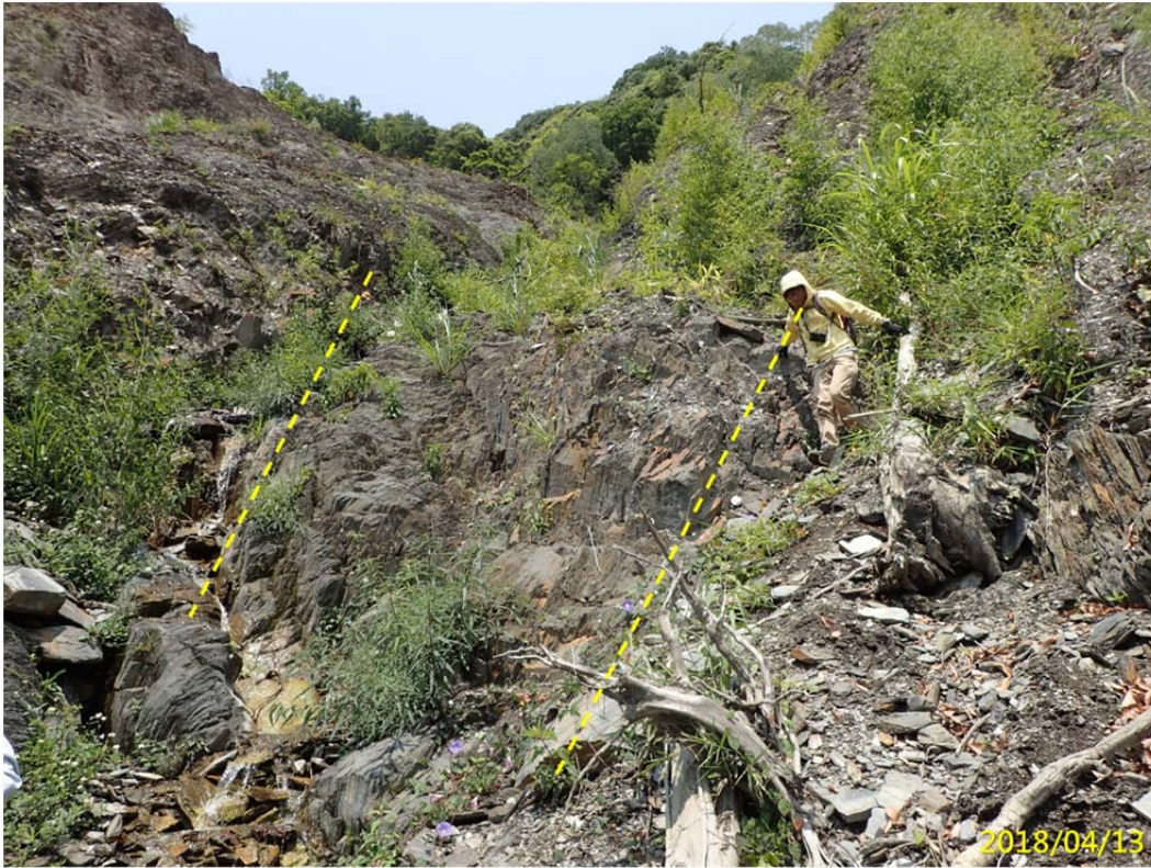
圖 3-20、廬山聚落坡趾露頭。主要為粉砂質板岩間夾砂岩
