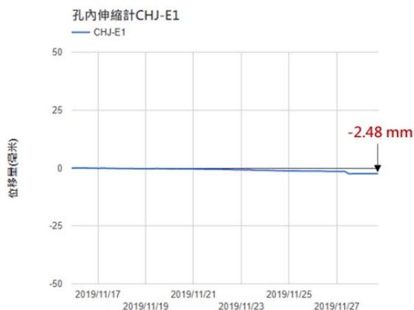
(a) CHJ-E1 孔內伸縮計(與測傾管共構)
