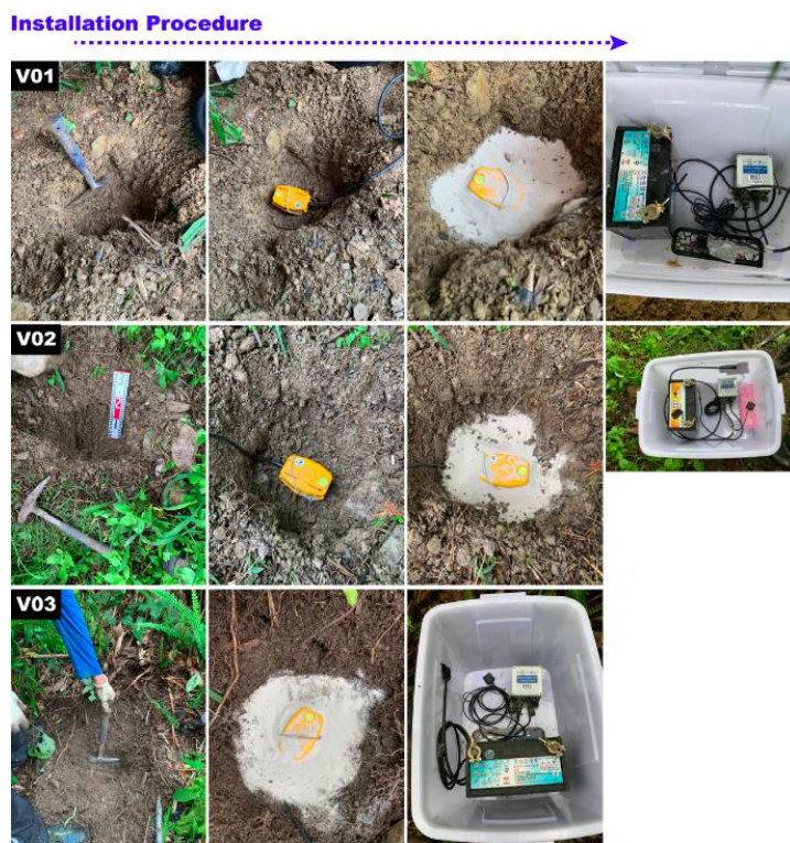
圖 4.2.3-2 測站 V01-V03 地聲計、DATA-CUBE3 訊號記錄器配置圖 Figure 4.2.3-2 The photos show the installation of geophone (G) and data logger
