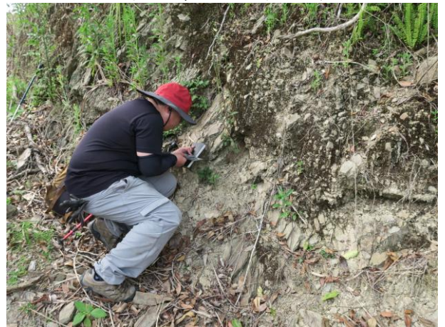
照片 7.場址外上邊坡側出露的板岩，研判屬四稜砂岩內所夾之板岩
