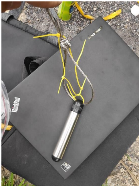
圖 4.1.2-15 108-D007-1W 水位計安裝過程實況
