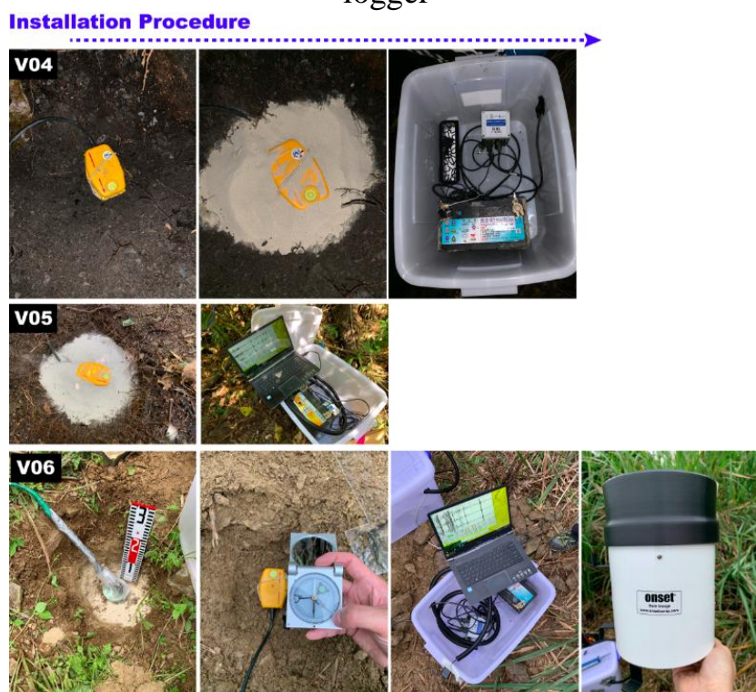
圖 4.2.3-3 測站 V04-V06 地聲計、寬頻地震儀、雨量計、DATA-CUBE3 訊號記錄器配置圖
