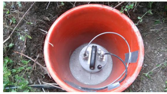
(d) 地震儀架設示意圖，其中桶內儀器必須進行指北與水平調整
