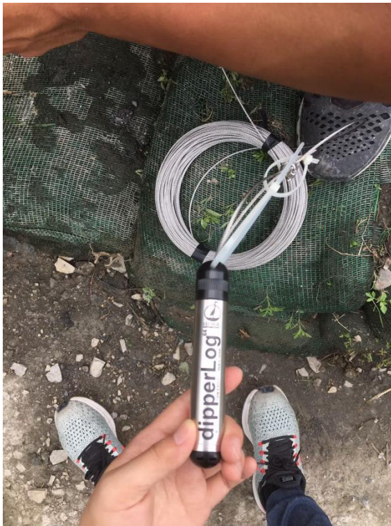
圖 4.1.2-17 108-D007-4W 水位計安裝過程實況
