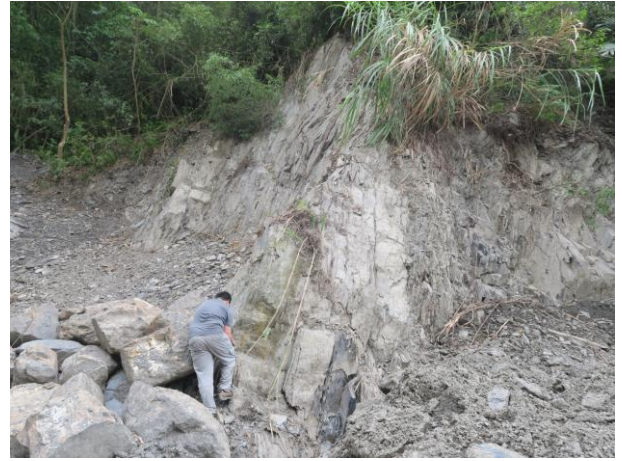
照片 9.場址下邊坡侵蝕溝內的老崩積層
