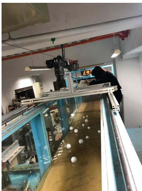
圖2-3 試驗渠槽與攝影機架設環境
