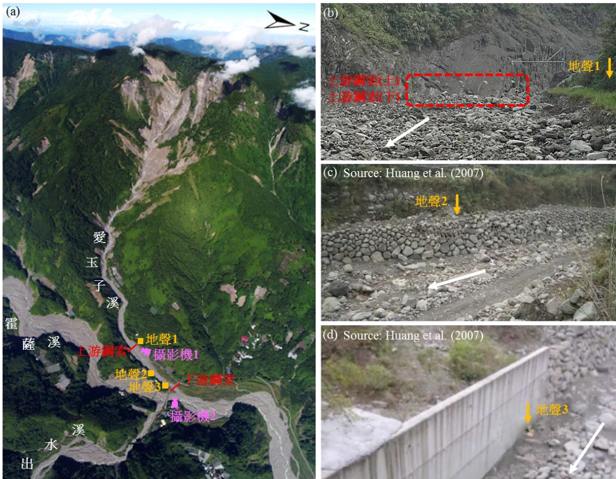
圖3-2 愛玉子溪地聲監測位址與埋設環境照片；(a)為愛玉子溪集水區航拍圖，拍攝於2017年7月15日；(b)、(c)、(d)為地聲的埋設位置照片，其中(b)拍攝於2016年3月31日，(c)與(d)引用自 Huang et al. (2007)
