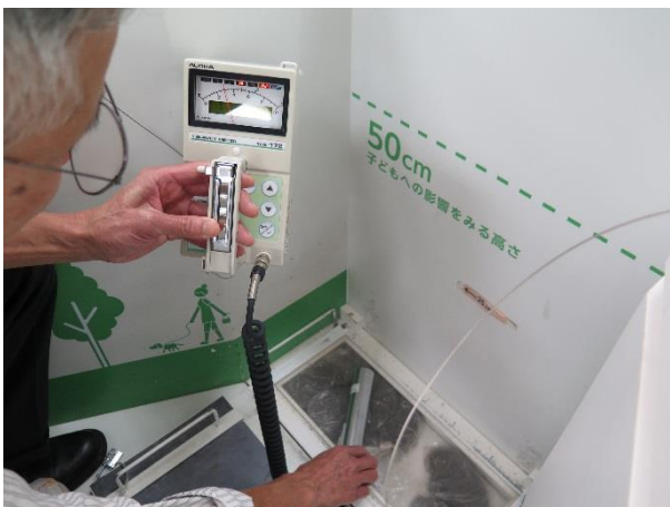
丸谷聡主査實際量測與展示災區受污染土壤的輻射劑量 (約 3.23 微西弗/小時左右)
