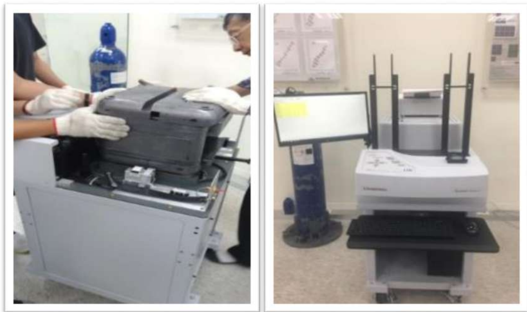
圖 2 比例計數器(鉛屏蔽)組裝過程(左)及儀器安裝完成(右)
