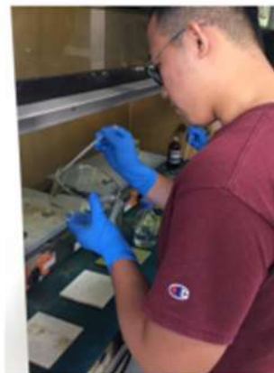
以硝酸溶液淋洗結晶皿
