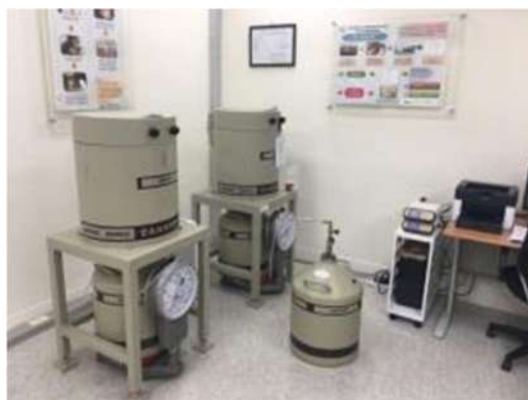
圖 4-2 兩套半導體純銻偵檢器
