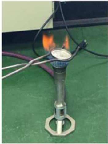
利用本生燈高溫火烤螺紋計測盤 利用本生燈高溫火烤螺紋計測盤
