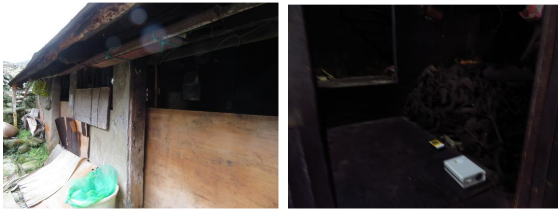
圖 4.2.3 蘭嶼傳統地下屋於屋簷下有氣窗可維持室內通風(左)，氡氣量測為置於住戶睡覺空間頭部位置(右)。
