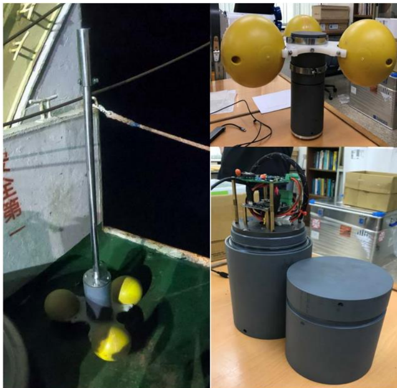
圖 21：獨立型省電式波浪儀小型浮標外觀與內部構造。
