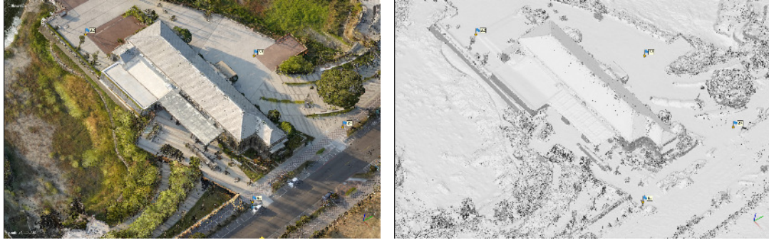
圖 4-50 UAS 影像建模情況
