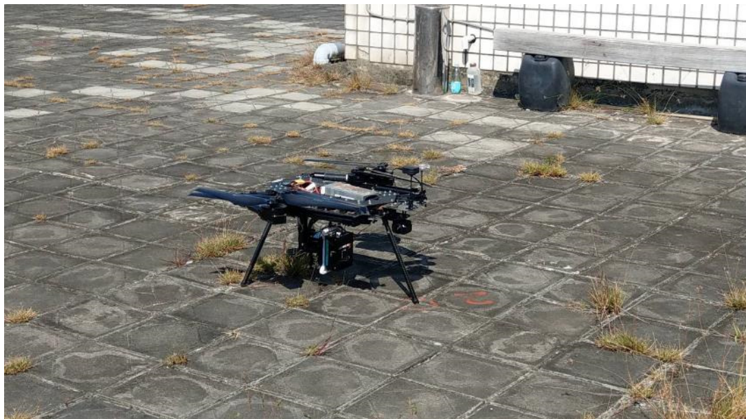
圖 4-10 定位定向系統單點定位精度實測資料蒐集情形
