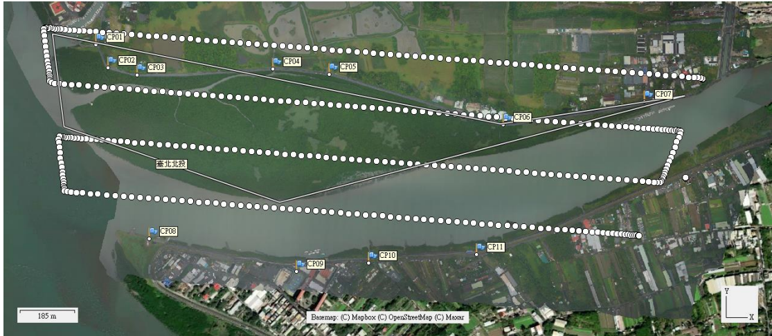
圖 3-12 臺北市北投區控制點及檢核點分布圖
