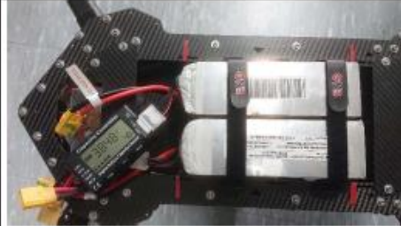
電池外觀 & 電池電壓
