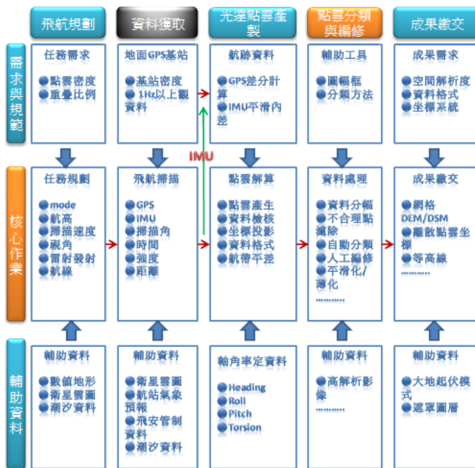
圖 1-3、以空載光達建立數值地形模型作業流程圖 3
