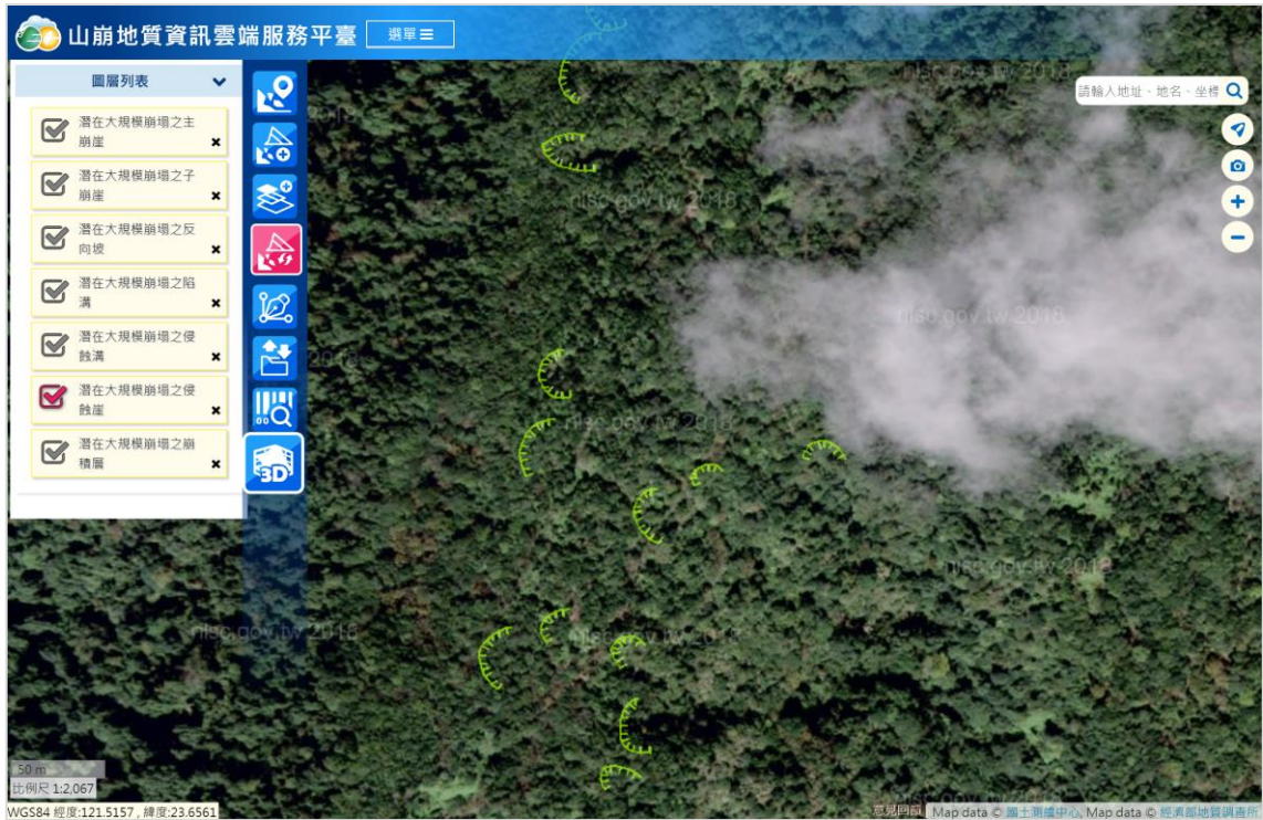
圖 21、潛在大規模崩塌地形特徵之侵蝕崖
