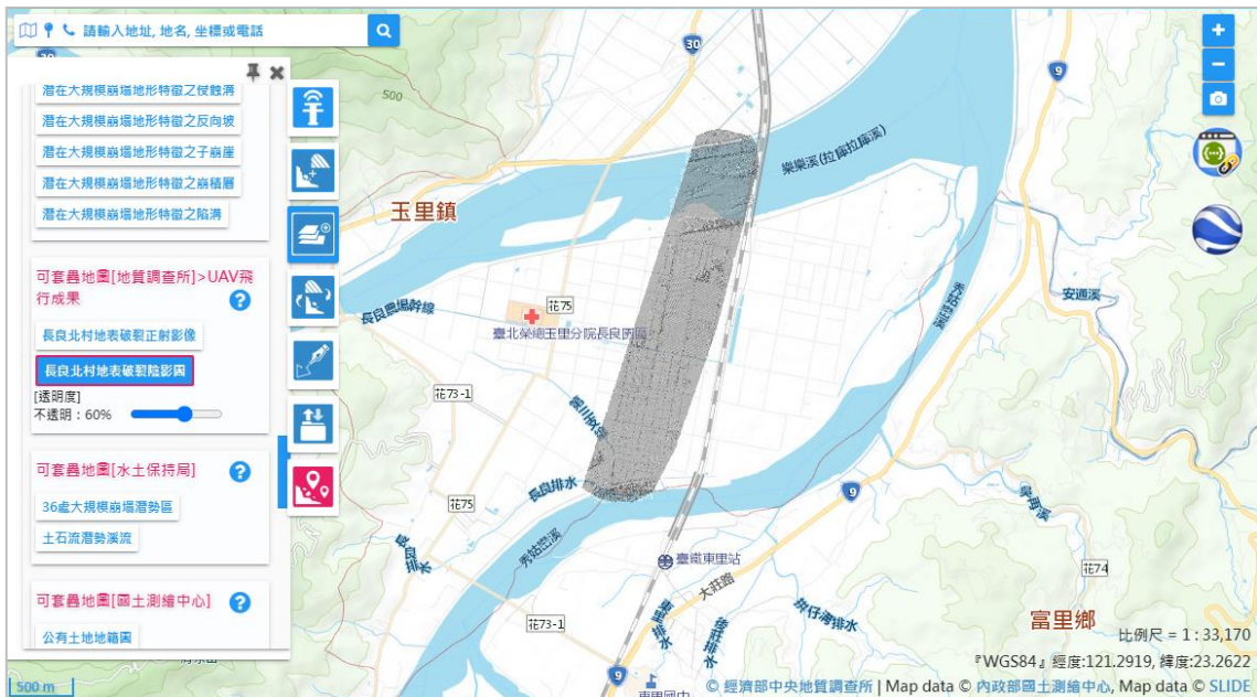
圖 40、長良北村地表破裂陰影圖
