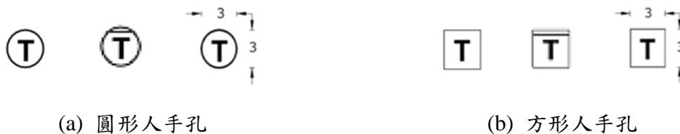
圖 4.2-33、電信人手孔圖例製作符號
