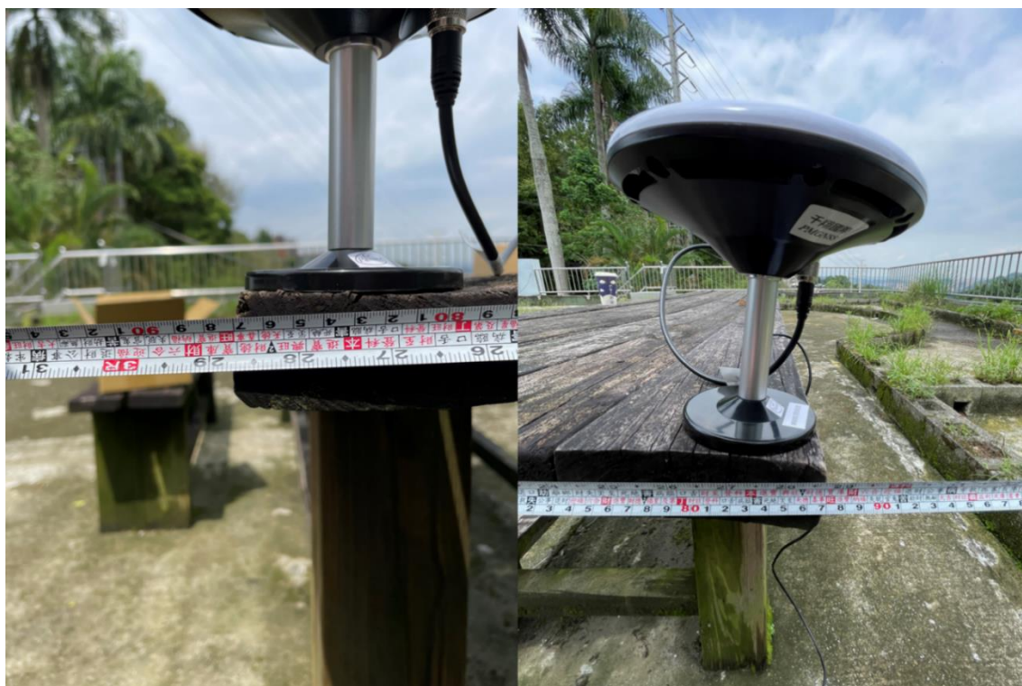
圖3-23 捲尺實際量測方法示意圖
