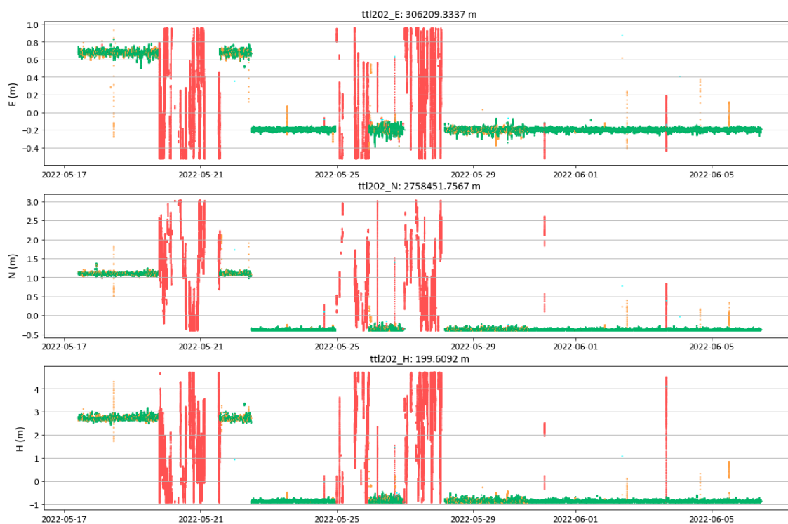
圖2-16 GNSS 設備測試期間穩定度時序分析結果(2022.05.17 至 2022.06.05)
