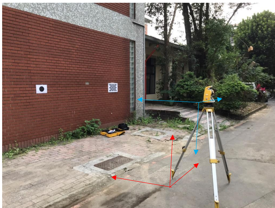
圖 3.13 全測站測量外參數矩陣之測試實驗；圖中紅色箭頭為世界座標系之軸、藍色箭頭則為攝影機座標系之軸
