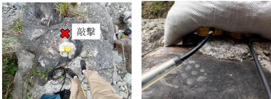
圖 3.8 愛玉子溪中游地聲檢知器檢定設置
