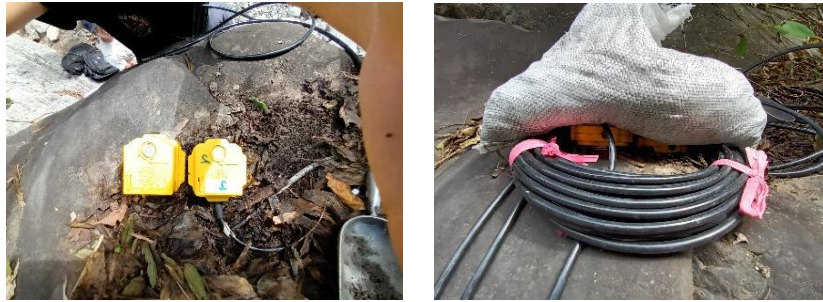
圖 3.7 愛玉子溪上游地聲檢知器檢定設置
