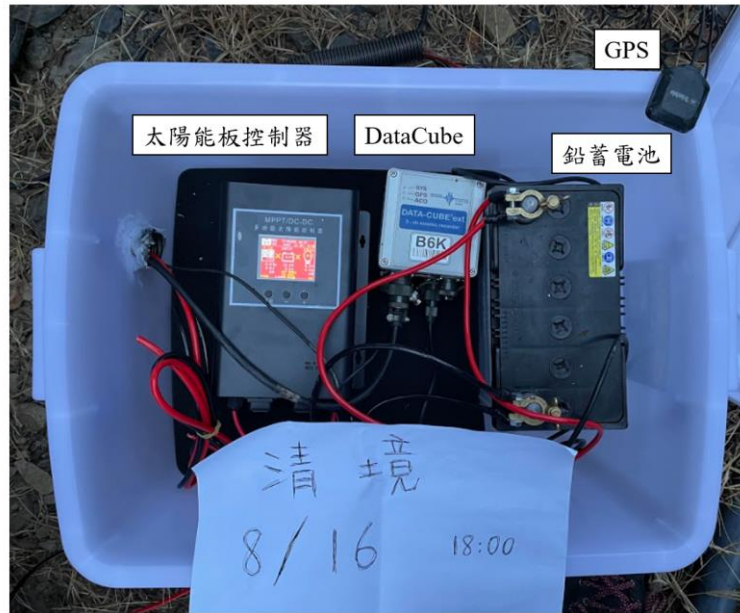
圖 4.14 清境站架站設備
