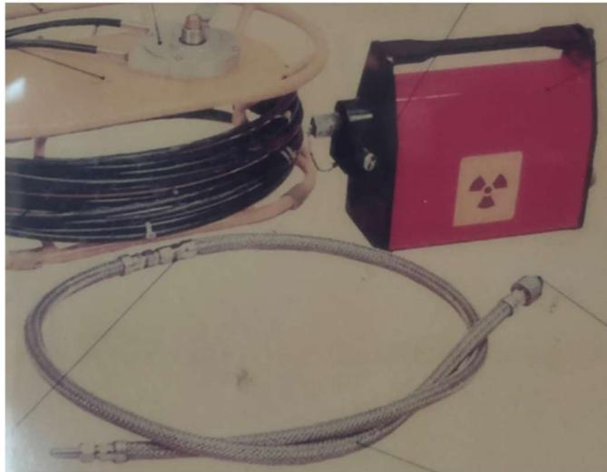
圖三-51 GAM100 加馬射線照射器。
