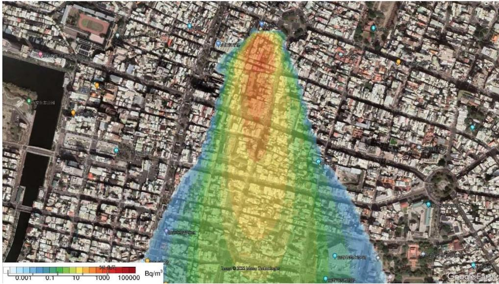
圖三-29 CALPUFF 模擬台南永樂市場輻射彈事件，風向為北風，核種為 Cs-137，15 分鐘累積柱狀空氣活度濃度分布(填色部分為濃度柱狀累積分布單位為  $Bq/m^3$ )。
