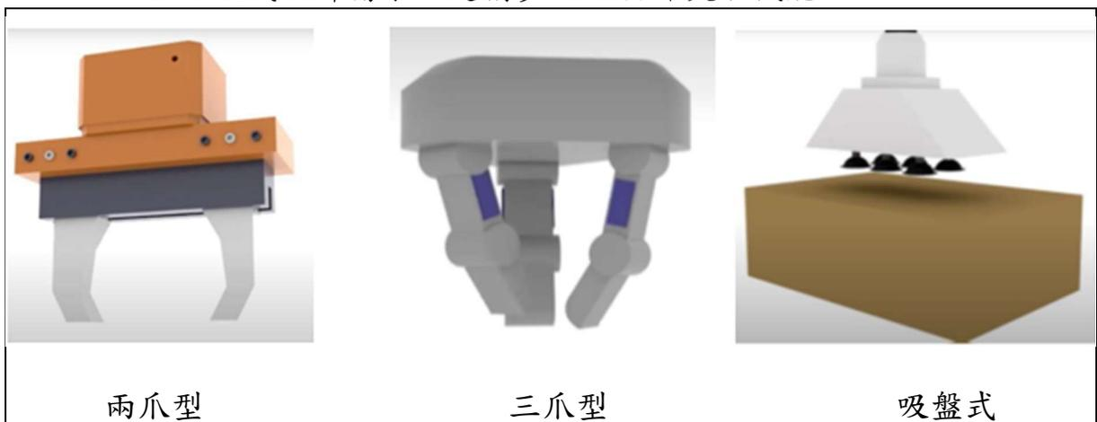
圖三-53 市售機械手臂常用夾爪類型
