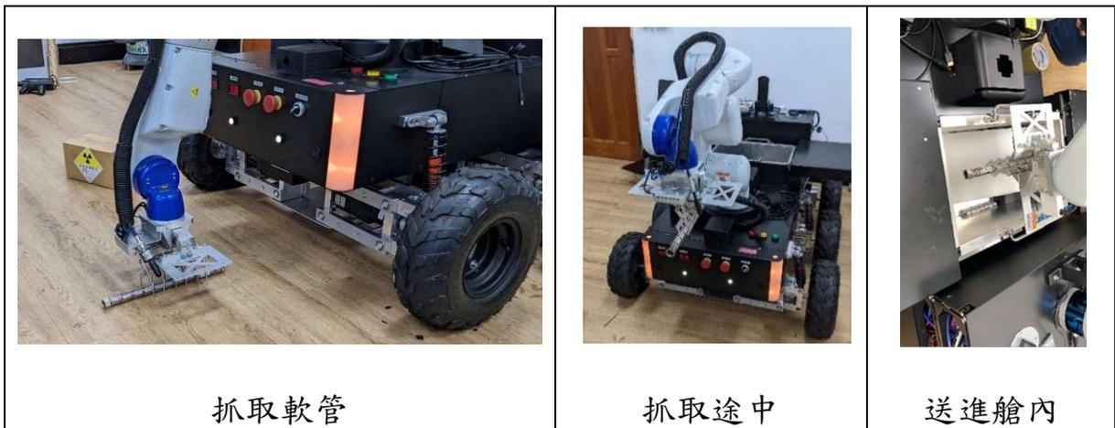
圖三-58 管式樣品抓取試驗
