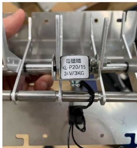
圖三-56 管式夾爪配置電磁裝置
