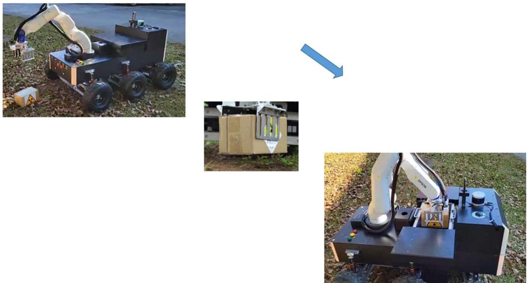
圖三-63 圖像式視覺物件夾取測試與電動收納
