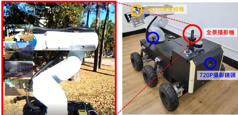
圖三-64 輻射偵測平台鏡頭配置與即時影像串流
