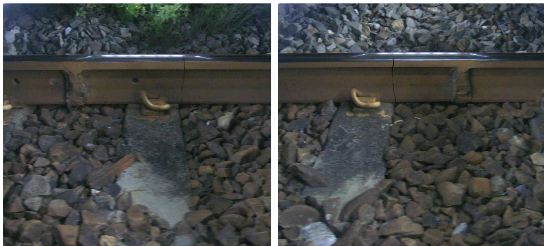
圖 4.13 合成軌腹裂縫示意圖
