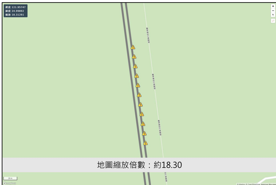
圖 4.35 隧道內模擬檢測軌道變異後融合定位資訊呈現圖
