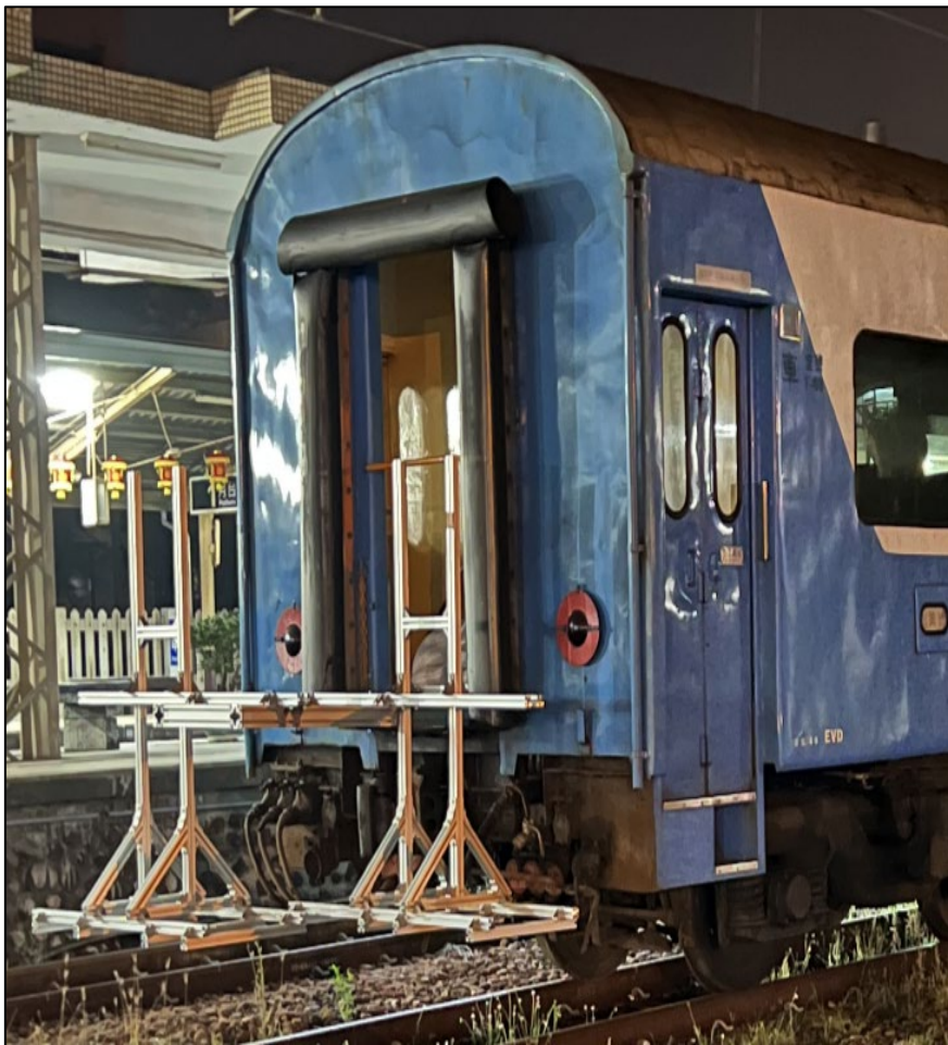
圖 4.1 復興號實車安裝影像採集機構
