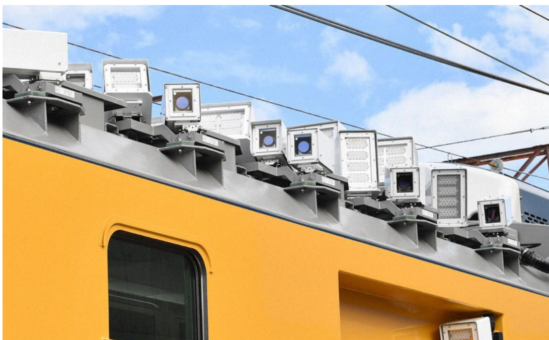
圖 2.12 DECA741 列車總計設有 64 組攝影設備 資料來源：日本每日新聞網 [24]
