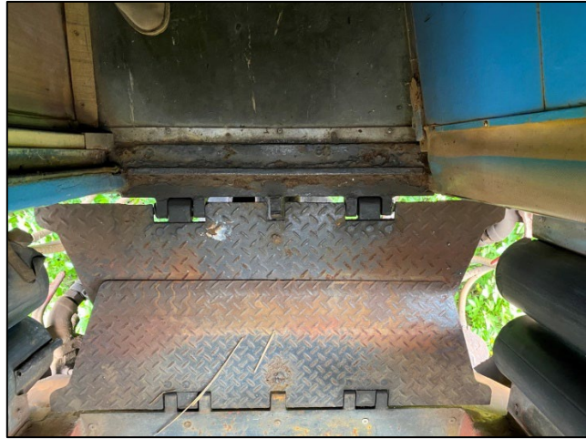
圖 3.9 復興號車廂外掛點位-車廂踏板位置
