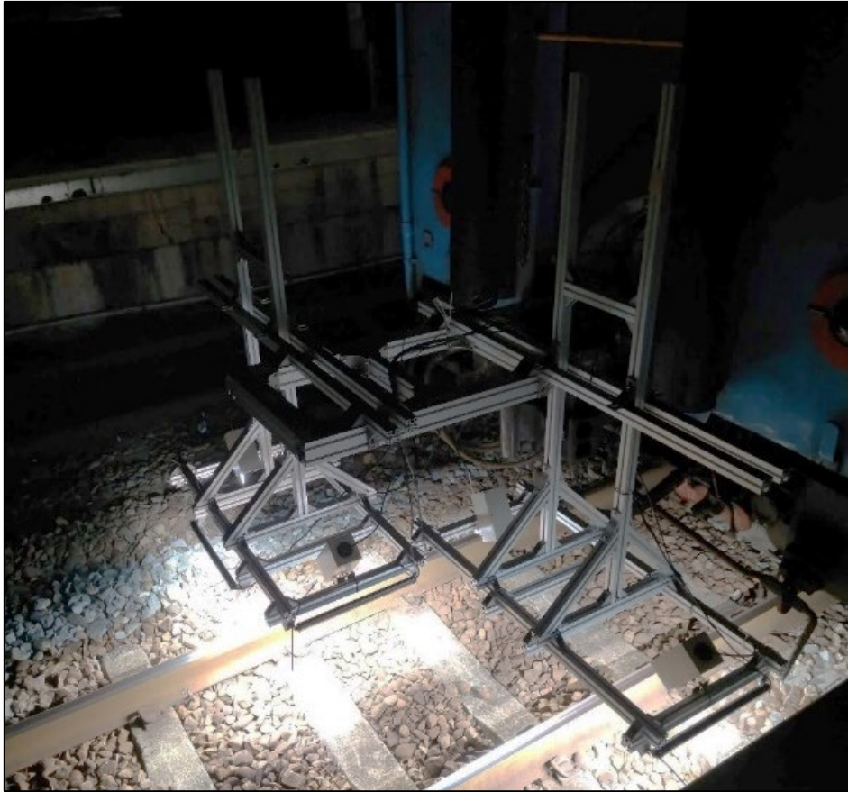
圖 4.2 影像採集機構安裝相機與燈光 資料來源：本計畫製作整理
