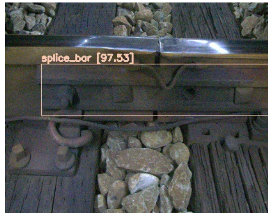
圖 4.40 第三階段臺中現地驗證檢出紀錄—魚尾鉸缺失
