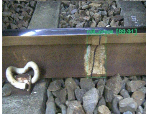
圖 4.41 第三階段臺中現地驗證檢出紀錄—鋼軌裂縫(模擬)
