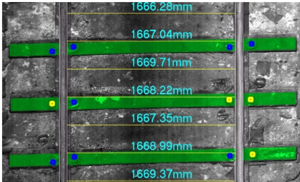
圖 2.10 LRAIL 偵測結果(軌道幾何偵測)
