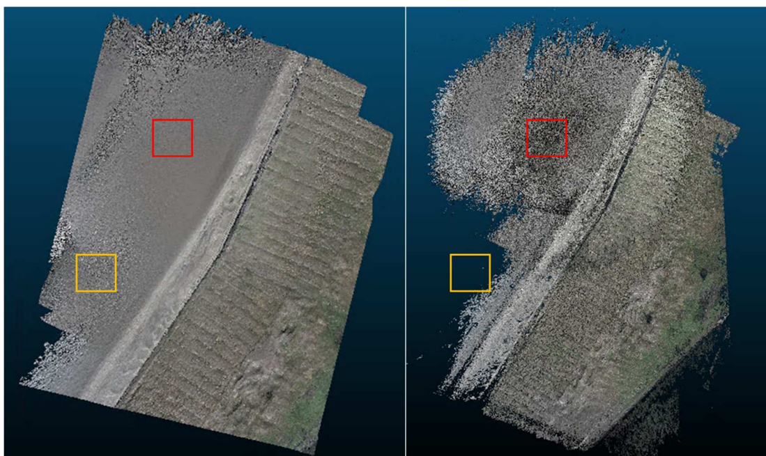
圖 8.21 PhotoScan 建模效果(左)與開源軟體建模效果(右)
