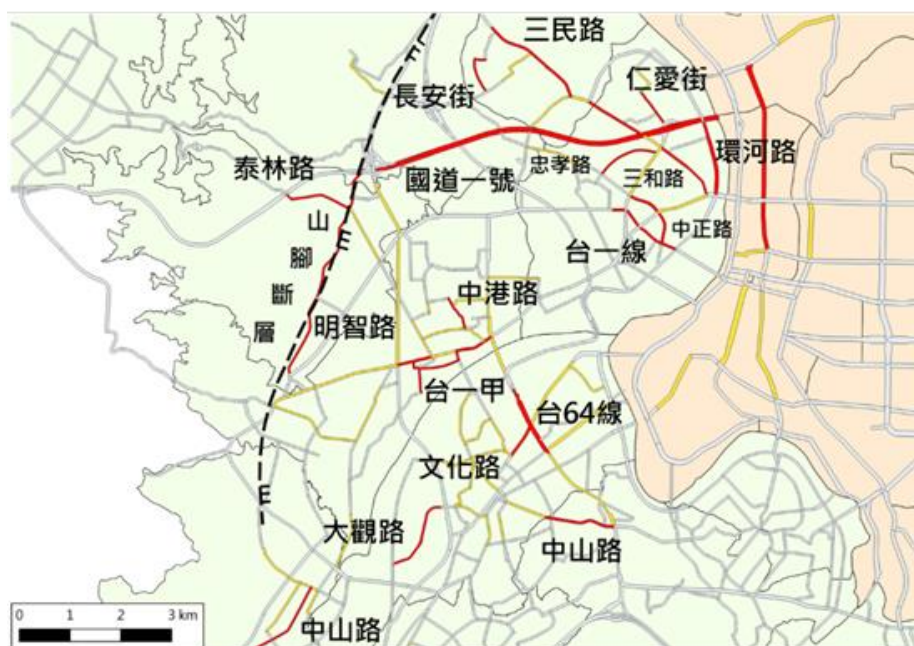
圖6-5 大台北地區想定地震境況下橋樑損壞引致阻斷風險示意圖
