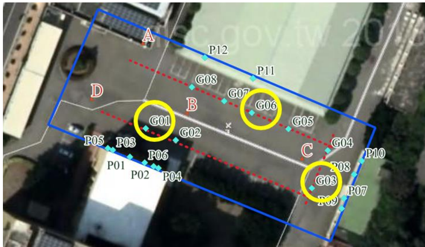
圖 5-1 本品保方案量測之校正標位置示意圖
