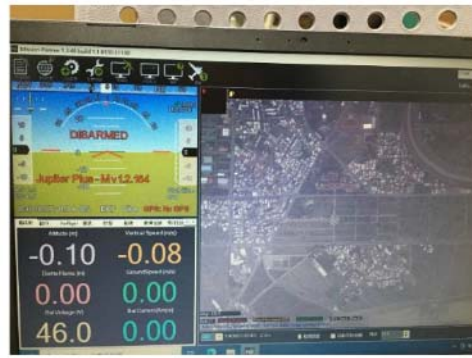
地面站電腦 & 地面站軟體運作
