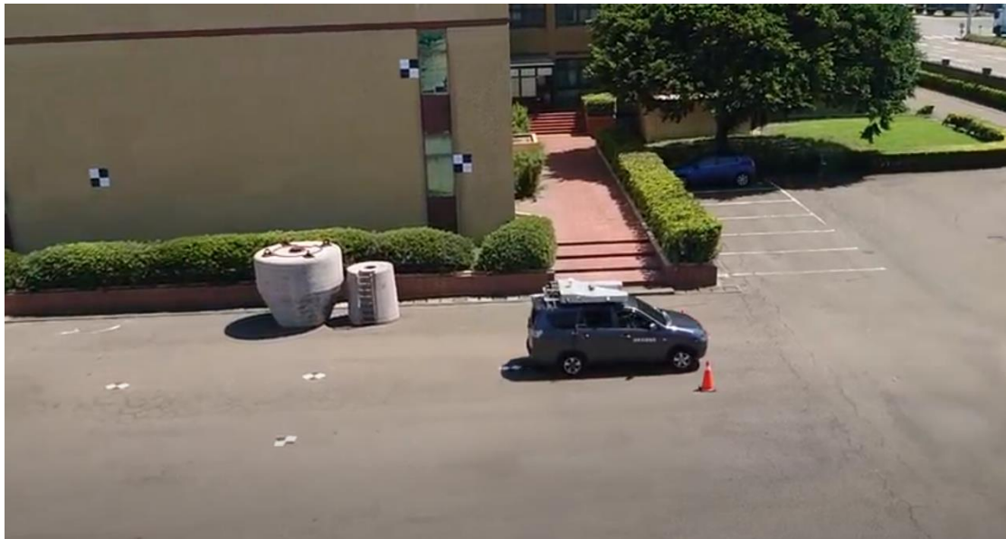
圖 6-12 光達掃描作業 1 (經緯公司光達測繪車)
