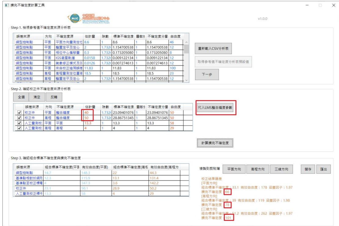
圖 3-46 擴充不確定度計算模組-代入校正件整合精度後計算擴充不確定度
