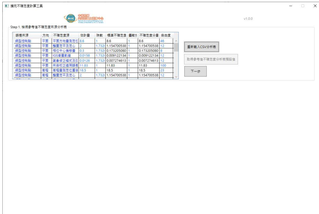
圖 3-33 擴充不確定度計算模組-讀取預設參考值不確定度源估計量
