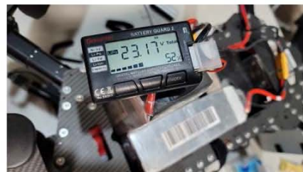
電池外觀 & 電池電壓
