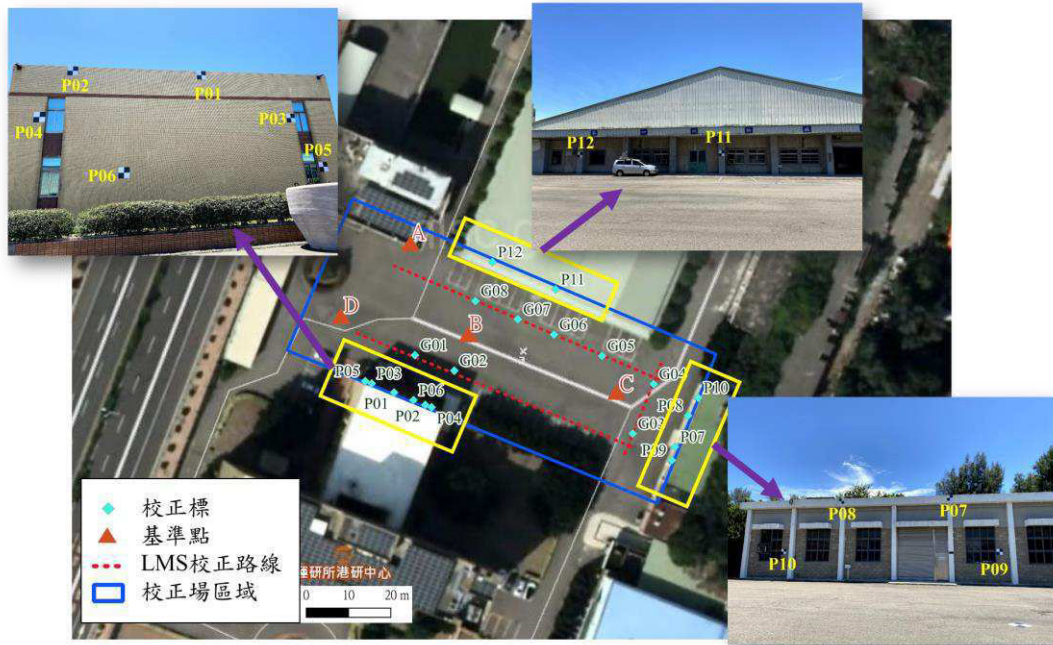
圖 2-3 校正場基準點與校正標分布示意圖
