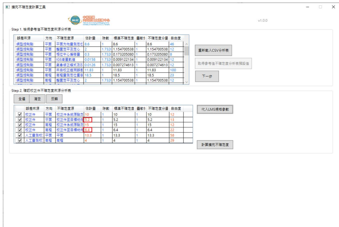
圖 3-35 擴充不確定度計算模組-讀取校正件不確定度源估計量
