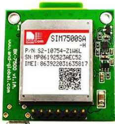
SIM7500SA採UART通訊界面 以AT command 進行控制
