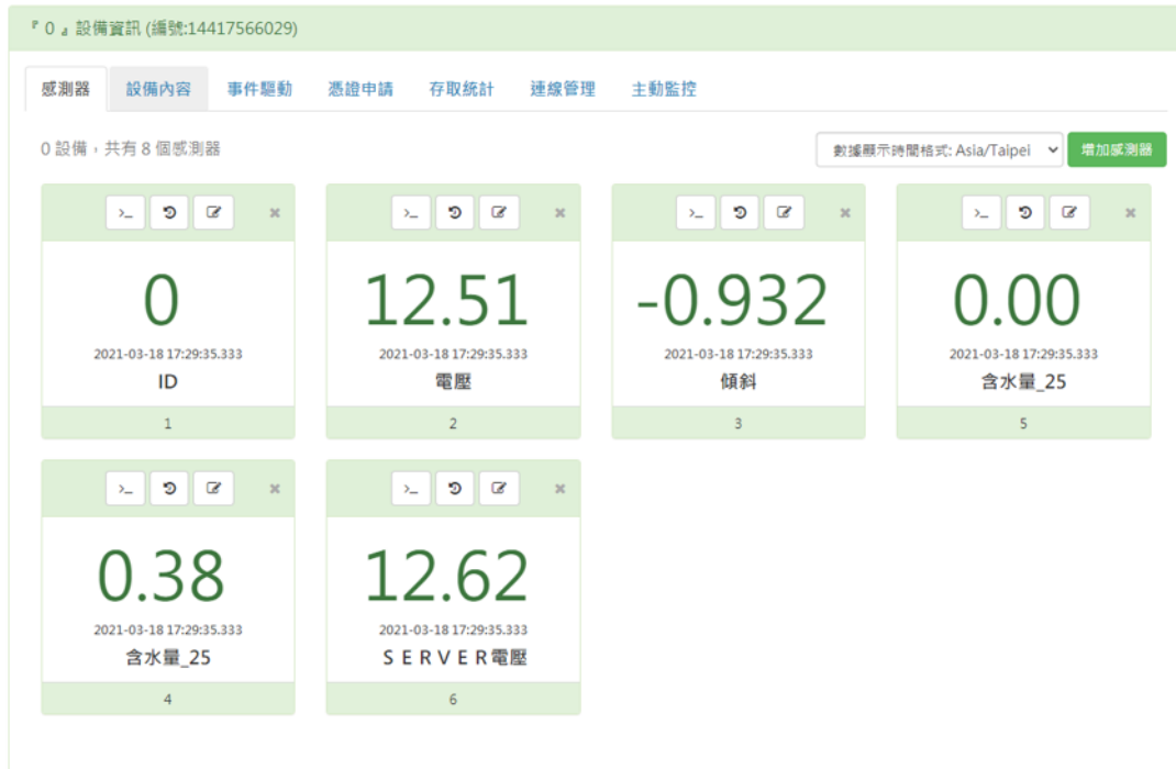
圖 3.14 中華電信 IOT 大平台雲端資料庫顯示頁面
