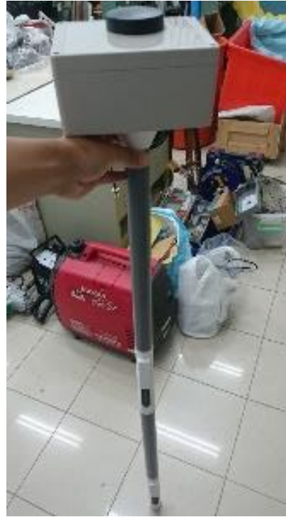
圖 3.16 土層監測模組外構
