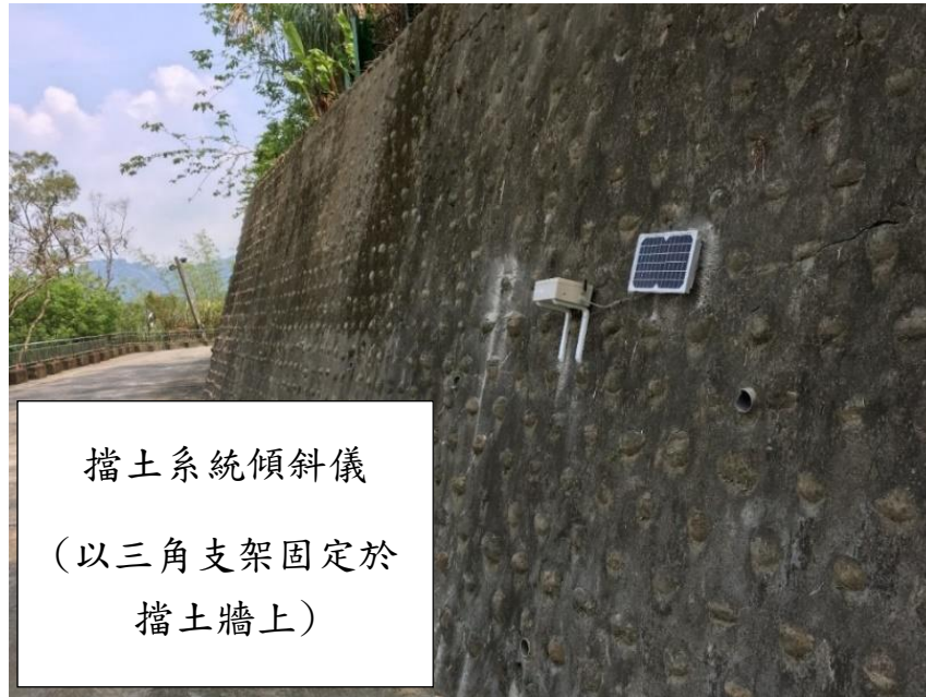
圖 3.19 擋土牆傾斜儀架設示意
