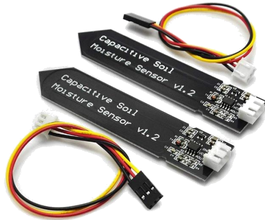
圖 3.8 新式類比輸出土壤電容水份計
