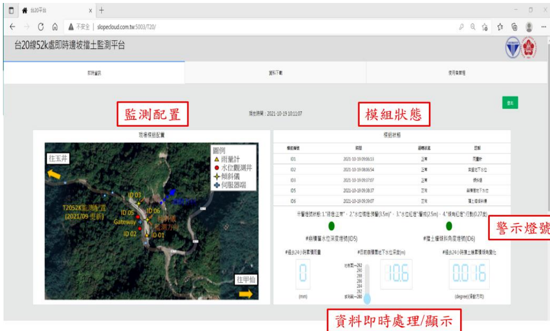
圖 3.24 雲端平台即時顯示資訊精進架構說明(1/2)
