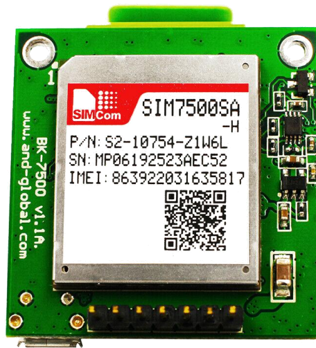
圖 3.31 4G/LTE 無線網路模組 (Sim-7500SA)
