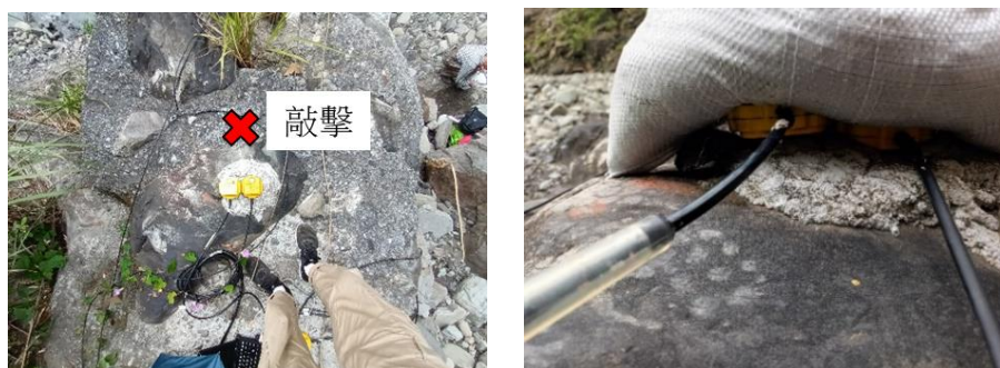
圖 2.8 愛玉子溪中游地聲檢知器檢定設置
