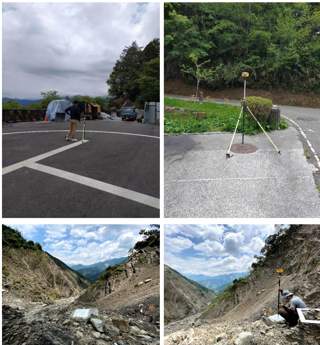
圖 4.11 祝山觀景台與愛玉子溪野溪的地面控制點量測
