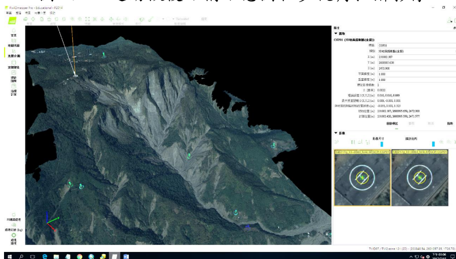
圖 4.15 Pix4D Mapper 航空攝影測量軟體產製三維模型示意圖
