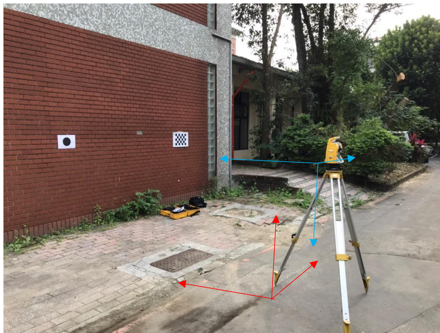
圖 2.12 全測站測量外參數矩陣之測試實驗；圖中紅色箭頭為世界座標系之軸、藍色箭頭則為攝影機座標系之軸
