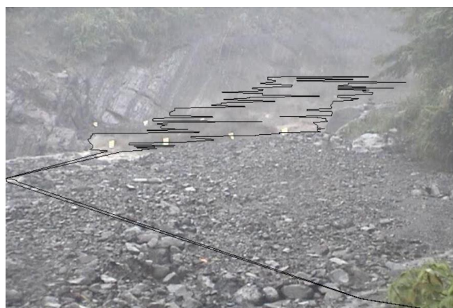
圖 3.10 土石流移動區域之邊緣偵測結果；a. 上邊緣偵測結果、b. 左右邊緣偵測結果
