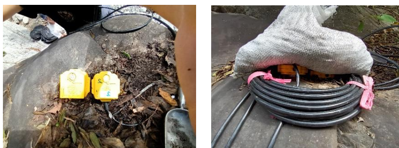
圖 2.7 愛玉子溪上游地聲檢知器檢定設置
