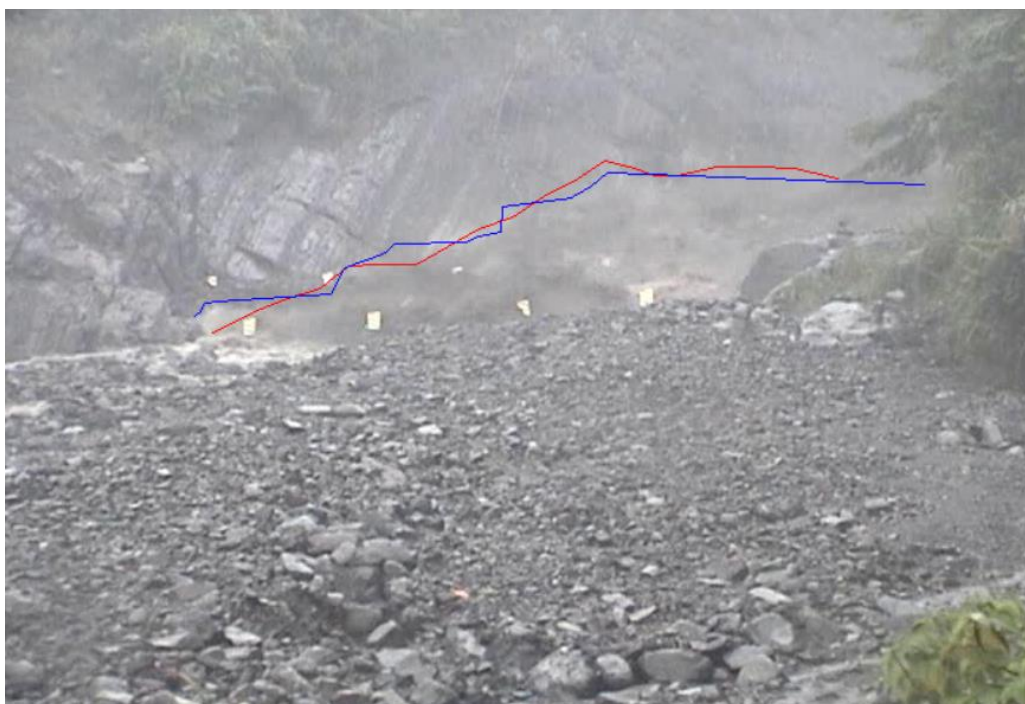
圖 3.12 土石流泥位高度實際值(紅線)與影像偵測值(藍線)
