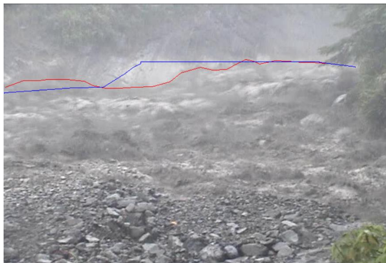
圖 3.13 土石流泥位高度實際值(紅線)與影像偵測值(藍線)
