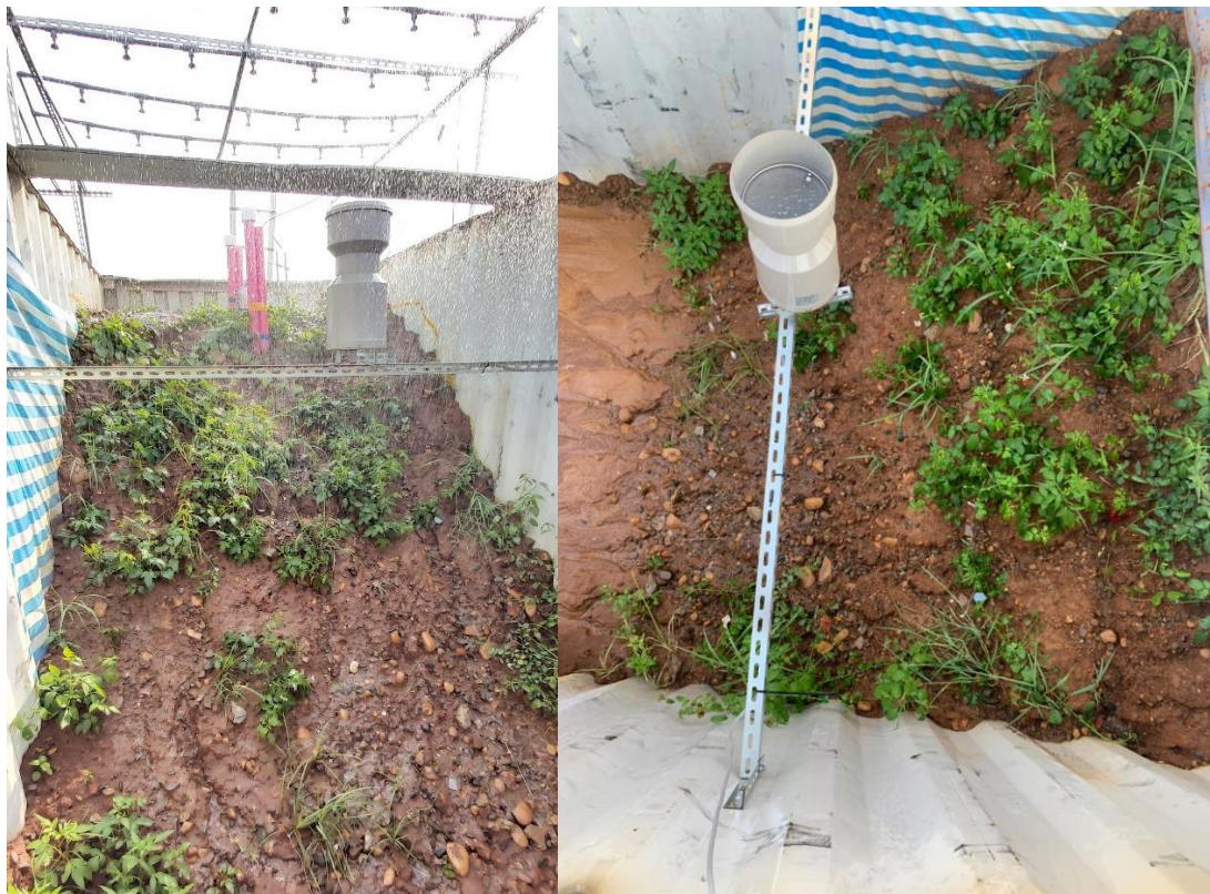
圖 3-30 人工降雨過程中沖刷出之蝕溝
