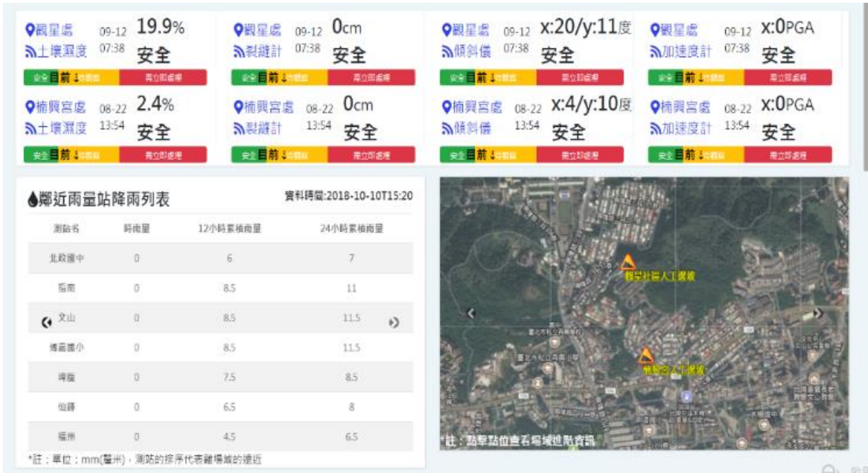
圖 5-5 工邊坡智慧監控系統首頁與子彈圖
