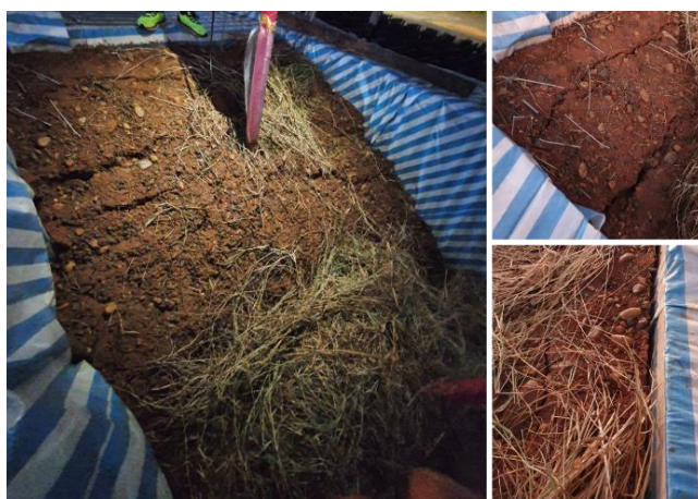
圖 2-3(b) 降雨驅動邊坡變形後照片
