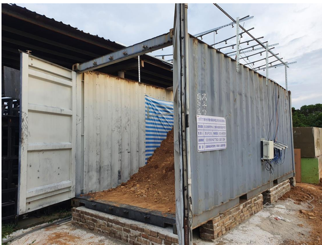
圖 3-15 大尺寸邊坡模型上方架設可調整降雨量之人工降雨裝置
