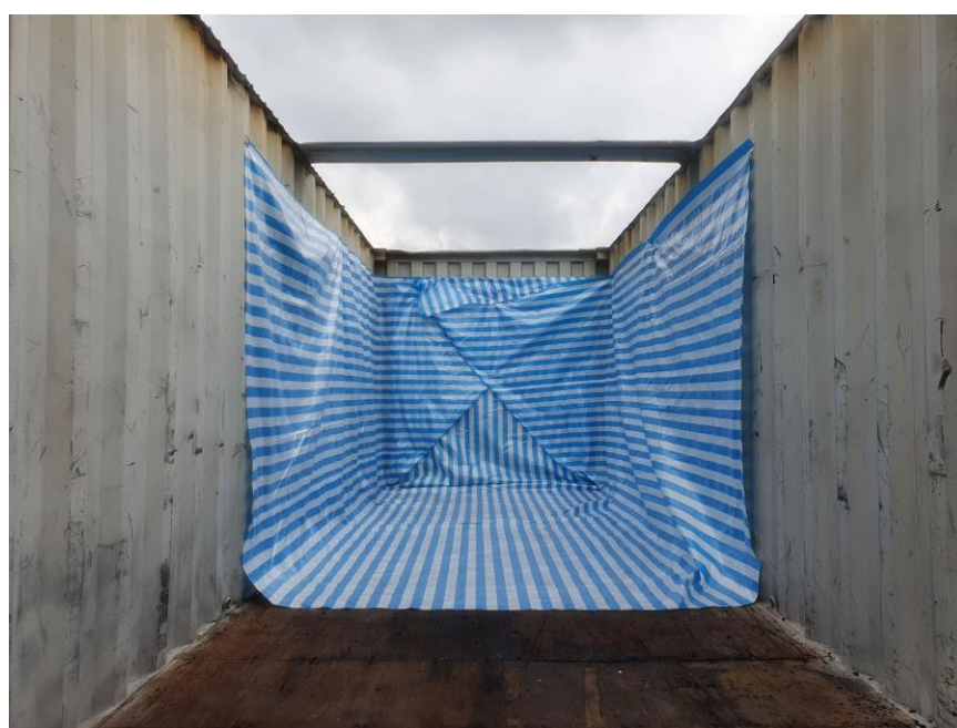
圖 3-3 土槽內部鋪設不透水帆布，上方保留 20cm 鋼板。
