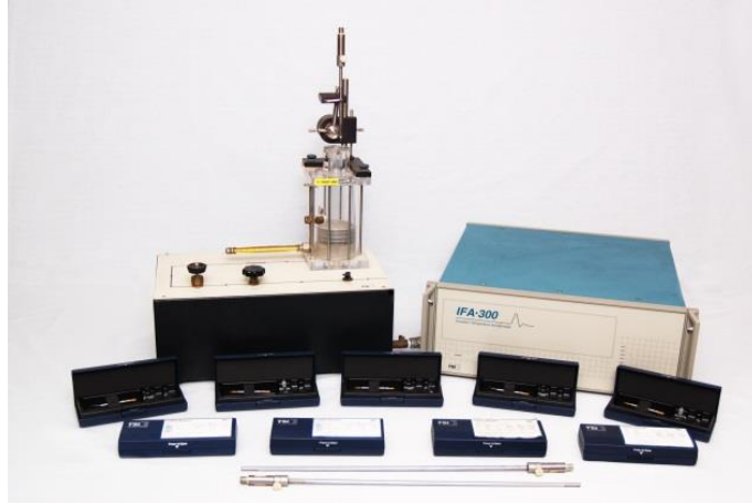
圖 4-3 IFA-300 智慧型風速儀、探針及校正儀 資料來源：【本研究整理】
