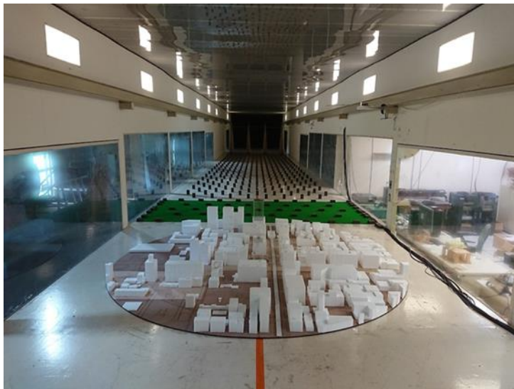
圖 4-15 內政部建研所風洞試驗設置照片(遠照) 資料來源：【本研究整理】
