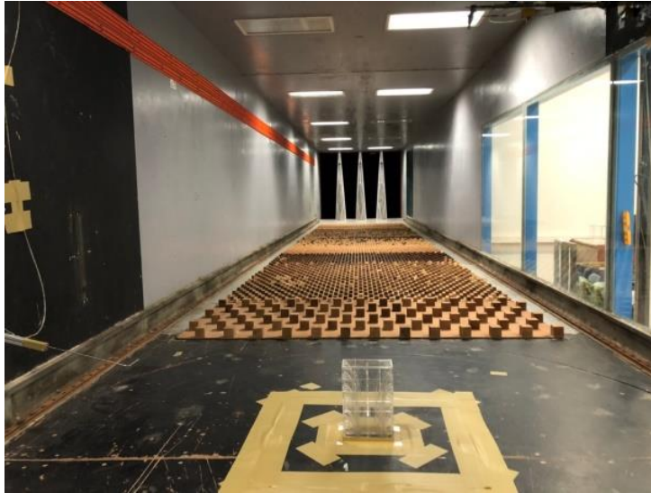
圖 4-13 風洞試驗設置照片 資料來源：【本研究整理】
