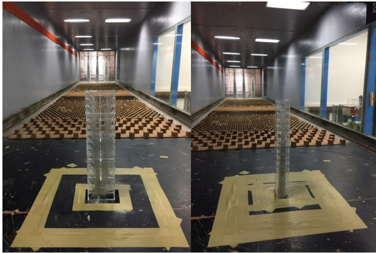
圖 4-9 高層建築物模型(左：高寬比 8 方柱；右：高寬比 8 矩柱)
