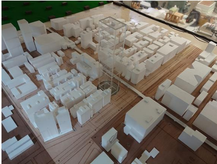
圖 4-14 內政部建研所風洞試驗設置照片(近照) 資料來源：【本研究整理】
