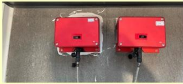
感測器固定方式(左為石膏、右為強力雙面膠)
