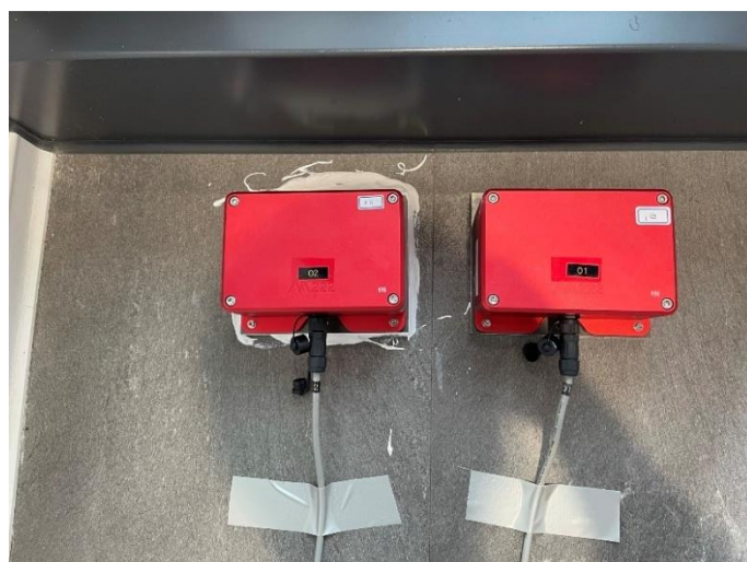
圖 5-12 感測器固定方式(左為石膏、右為強力雙面膠)
